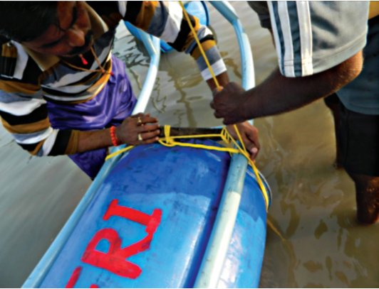
आकृती 7 : तरंगक पद्धती म्हणून वापरावयाची हवा भरलेली प्लॅस्टिकची पिंपे
