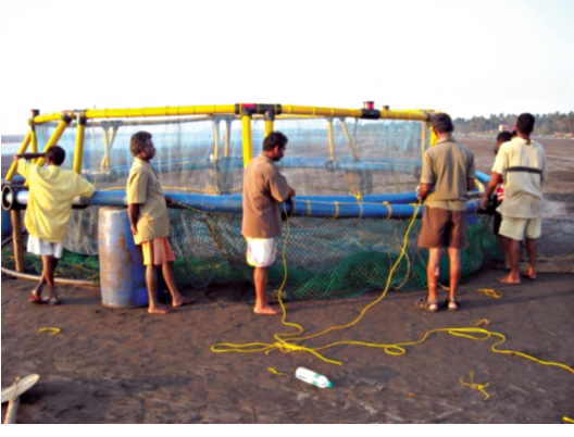
आकृती 6 : HDPE आणि जस्तविलेपित पाईपने बनवलेली कॉलर
