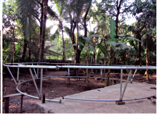
आकृती 6 : HDPE आणि जस्तविलेपित पाईपने बनवलेली कॉलर
