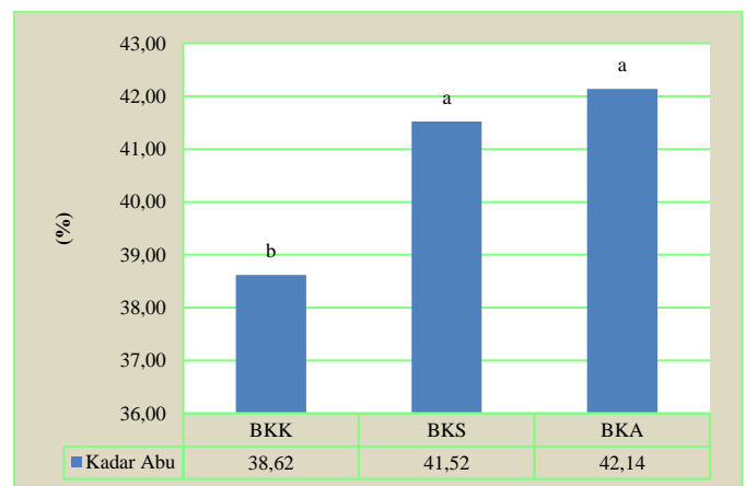
Gambar 2. Rataan kadar abu (%) briket dengan bahan dasar kotoran kambing, sapi dan ayam; Keterangan : Superskrip yang berbeda gambar menunjukkan sangat berbeda nyata ( P < 0,05 )
