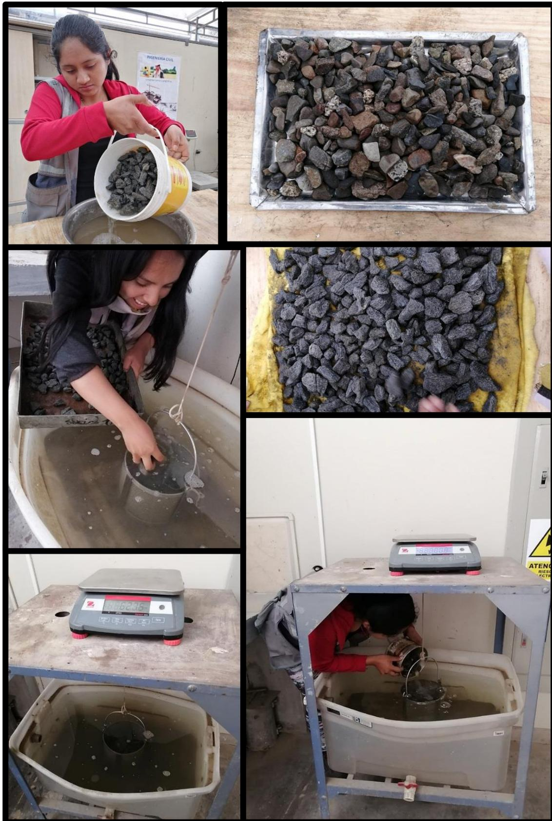
Figura 55: Procedimiento para elaborar el ensayo de peso específico y absorción – agregado grueso según la norma ASTM C127/ NTP 400.021
