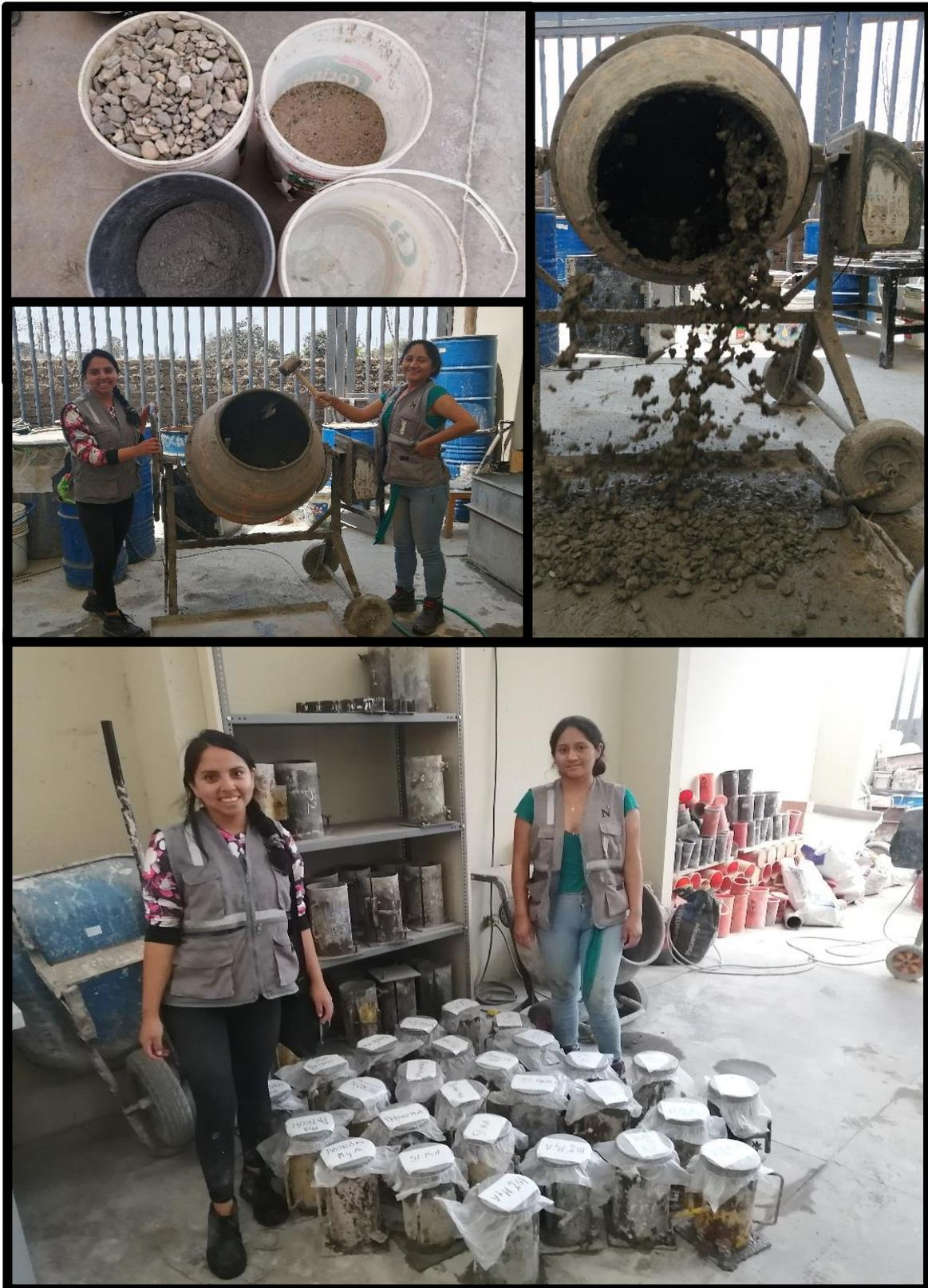
*Figura 56:* Procedimiento para la elaboración de probetas según la norma ASTM C192/NTP 339.183
