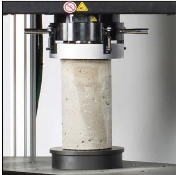
Figura 10: Ensayo de compresión
