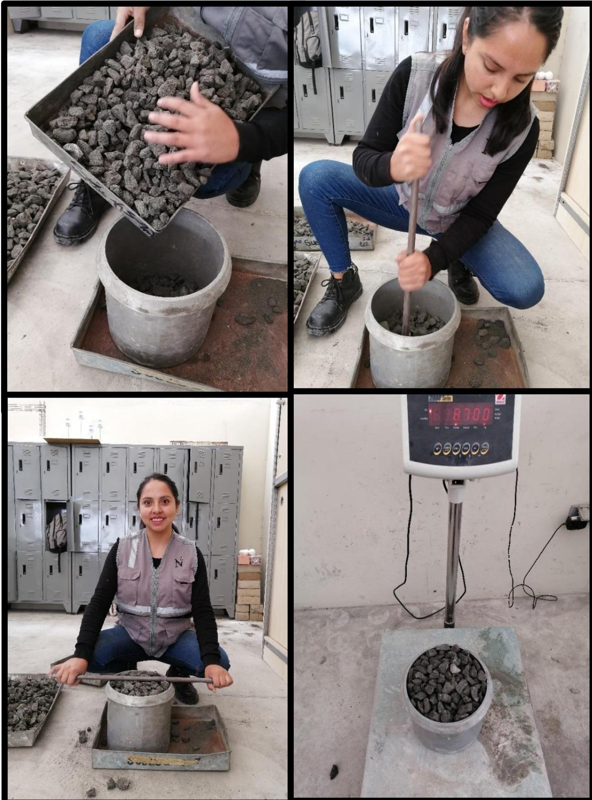
*Figura 54:* Procedimiento para elaborar el ensayo de peso unitario seco compactado de la piedra pómez según la norma ASTM C29/ NTP 400.017.
