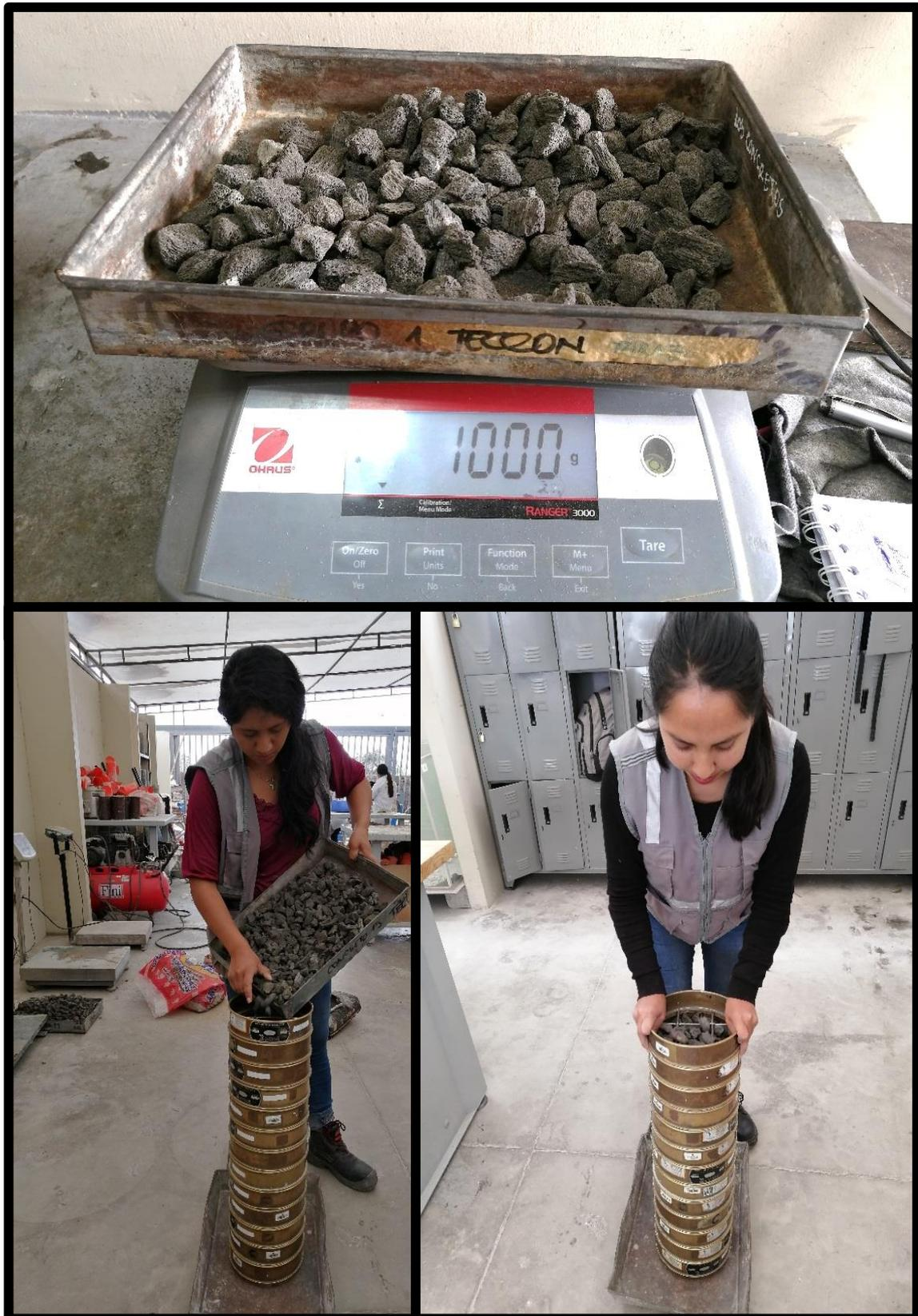
*Figura 52: Procedimiento para elaborar el ensayo granulométrico de la piedra pómez según la norma ASTM C136/ NTP 400.012*
