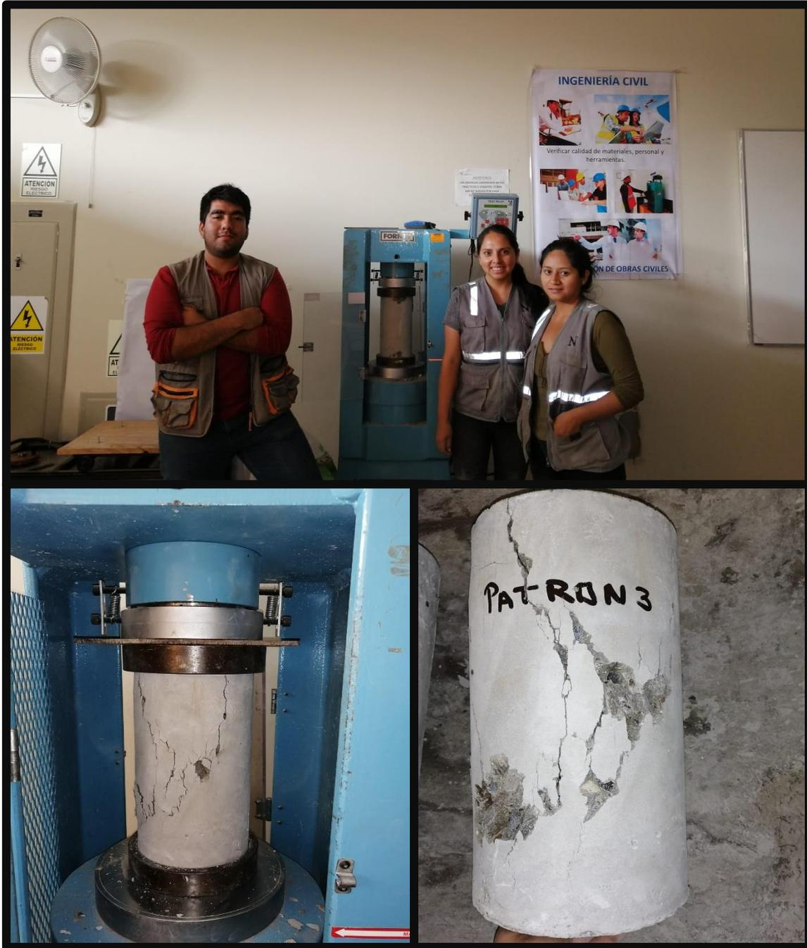
*Figura 58:* Procedimiento para elaborar el ensayo de resistencia la compresión según la norma ASTM C39 /NTP339.034
