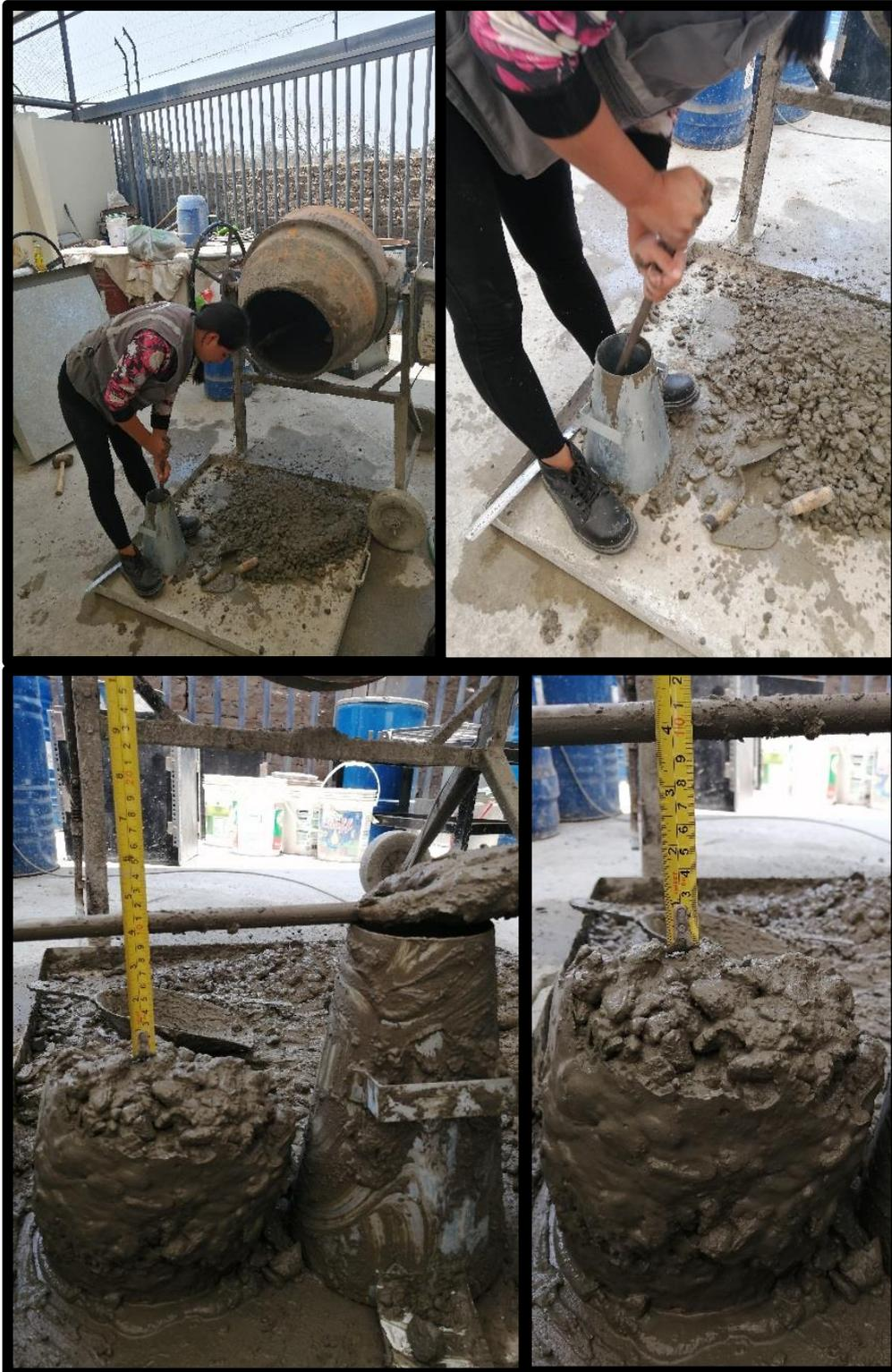
*Figura 57:* Asentamiento del concreto según la norma ASTM C143 / NTP 339.035 .
