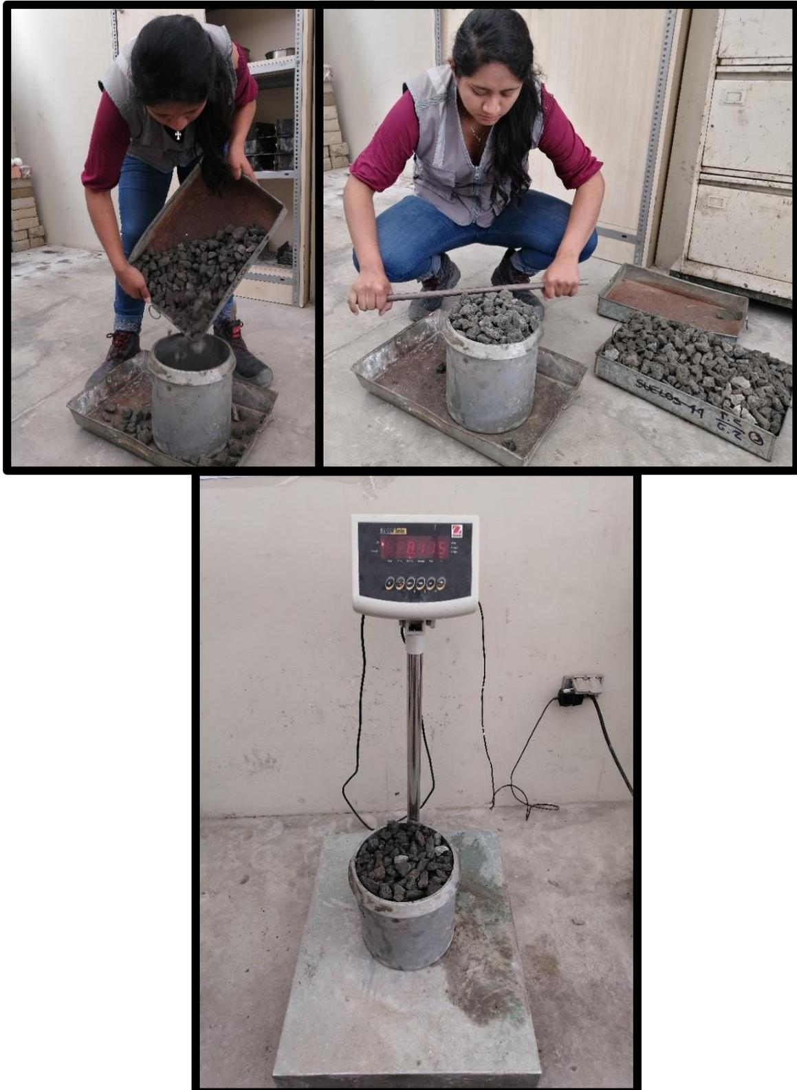
*Figura 53. Procedimiento para elaborar el ensayo de peso unitario seco suelto de la piedra pómez según la norma ASTM C29/ NTP 400.017.*
