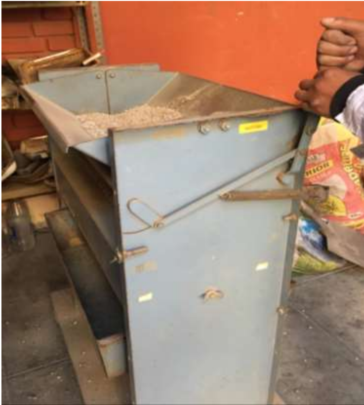
Foto N°3. Cuarteador de mineral
