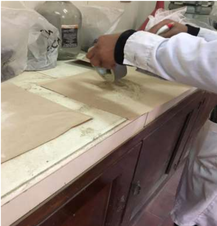
Foto N°20. Pulverización de la muestra de relave para su posterior análisis.
