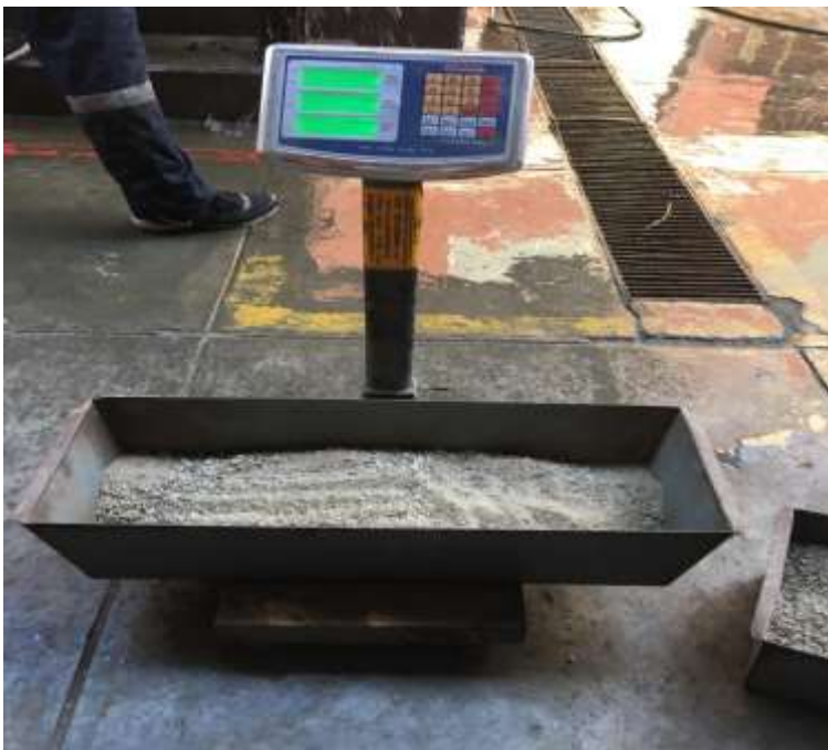
Foto N°4. Pesado de la muestra representativa de 12 kg para las pruebas de lixiviación necesarias.
