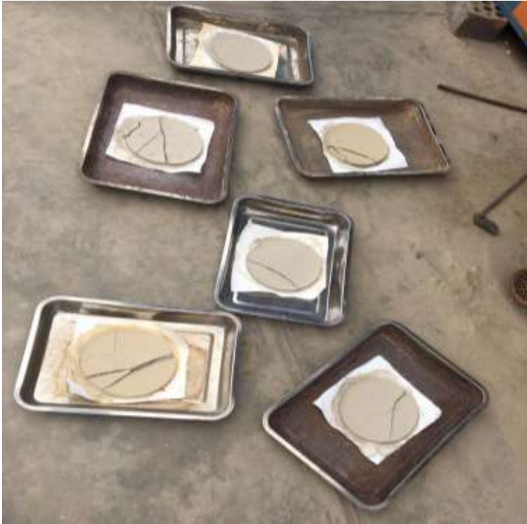
Foto N°19. Muestras de relave de mineral listas para el secado.
