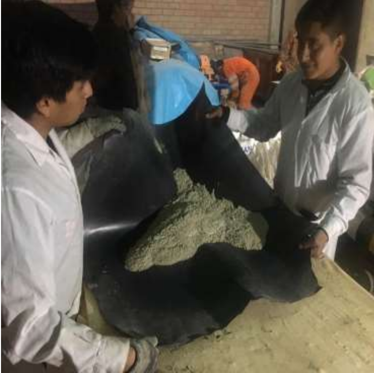
Foto N°11. Roleo de las muestras con la finalidad de homogenizar el mineral.
