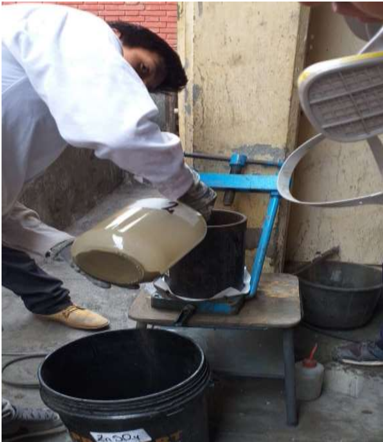
Foto N°17. Filtrando las muestras para obtener el relave y las solución.
