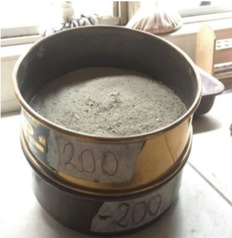
Foto N°8. Tamizado del mineral para precisar el pasante del 80% de sólido en la malla N° -200.
