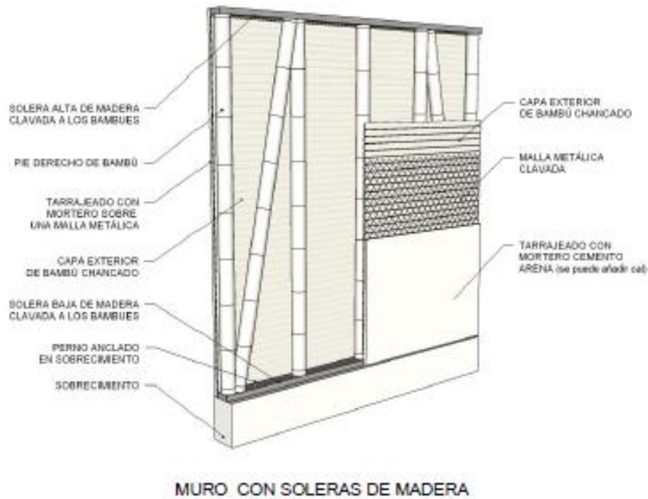
Figura 18. Muro con soleras de madera.
