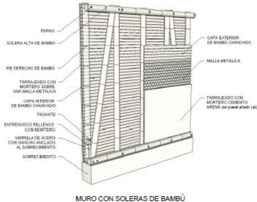
Figura 19. Muro con soleras de bambú.
