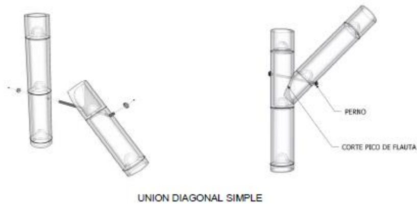
Figura 16. Unión diagonal simple
