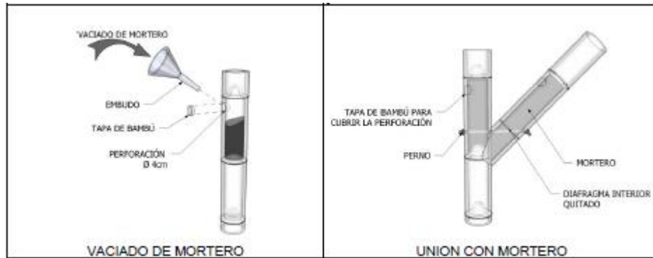
Figura 12. Uniones con mortero
