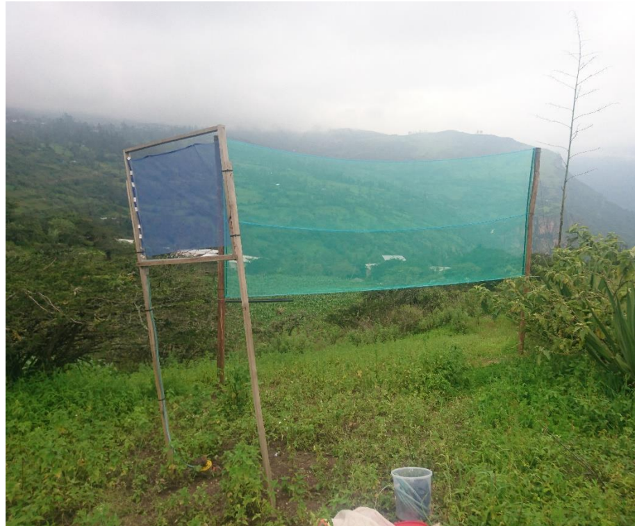
Figura 2. Construcción de atrapaniebla AN-01-02 y AN-21-01. (2018)
