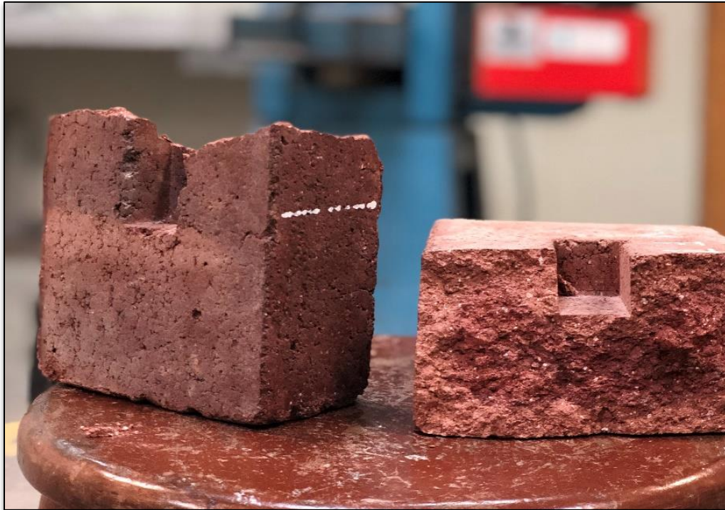
Figura 47: Vista en corte del ladrillo de tierra comprimida cocida en horno industrial.
