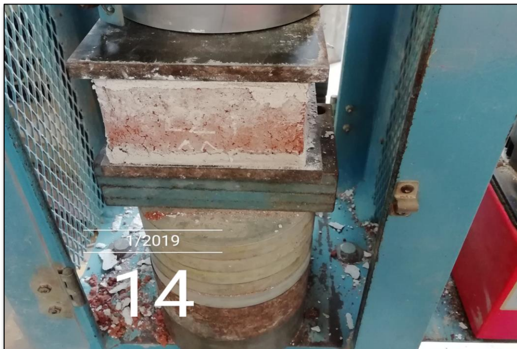
Figura 76: Ensayo de resistencia a la compresión.
