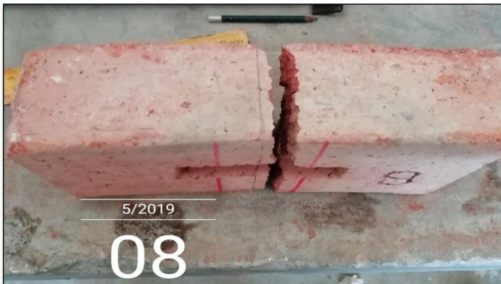
Figura 70: Fractura en medio de la muestra .
