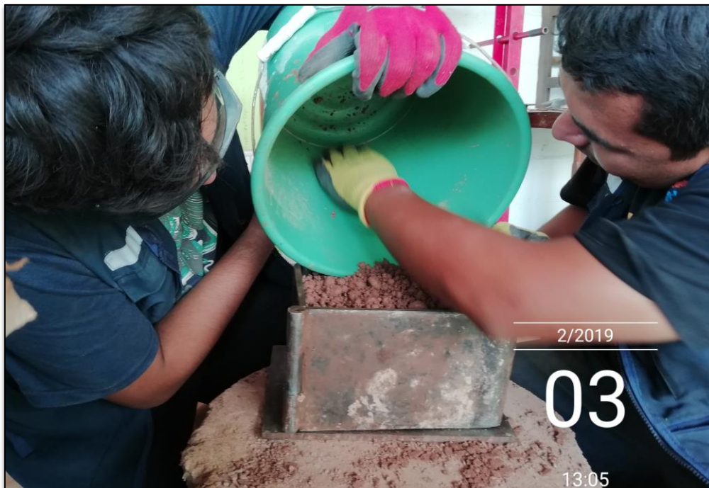
Figura 24: Llenado de material en molde.
