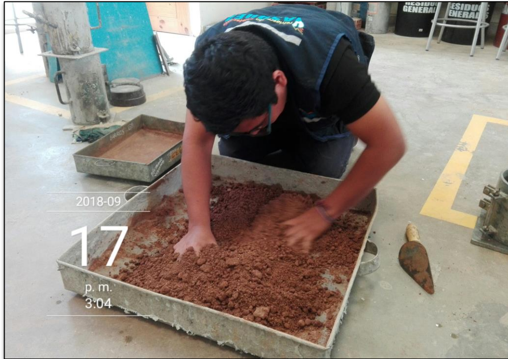
Figura 5: Mezcla de arcilla con 12% de agua indicada.
