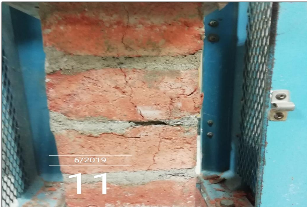
Figura 84: Ensayo de resistencia a la compresion por pila.
