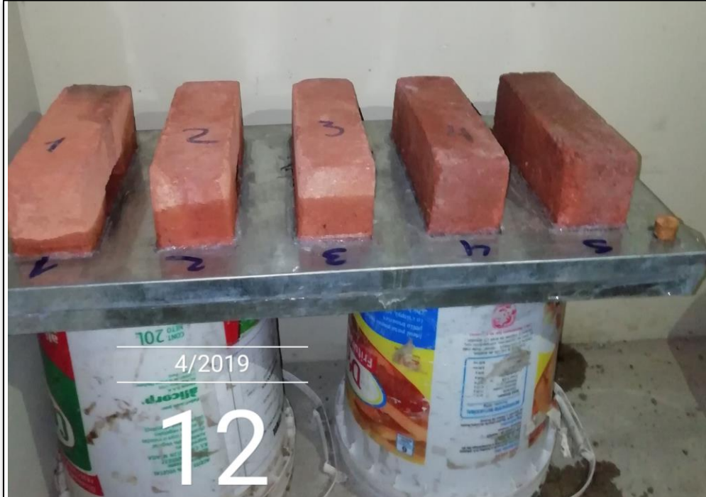
Figura 57: Ladrillos colocados en bandeja, sumergidos en agua destilada.
