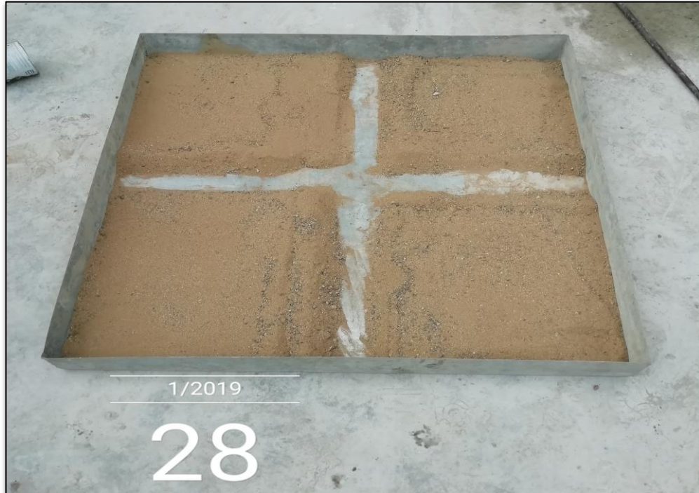
Figura 9: Cuarteo de arena para posterior caracterización de material.
