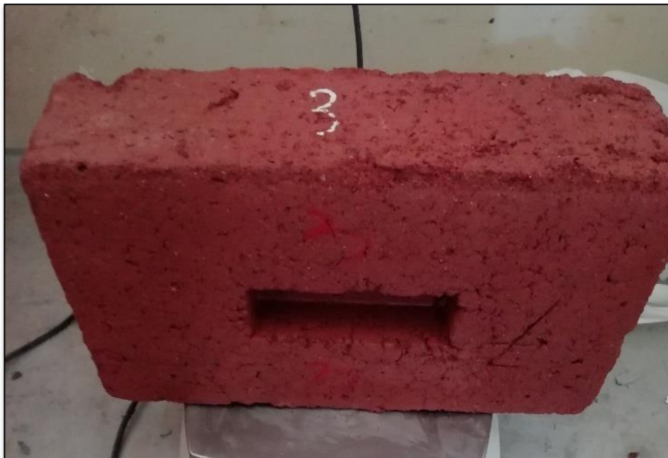
Figura 52: Extracción de ladrillo sumergido luego de 24 horas.
