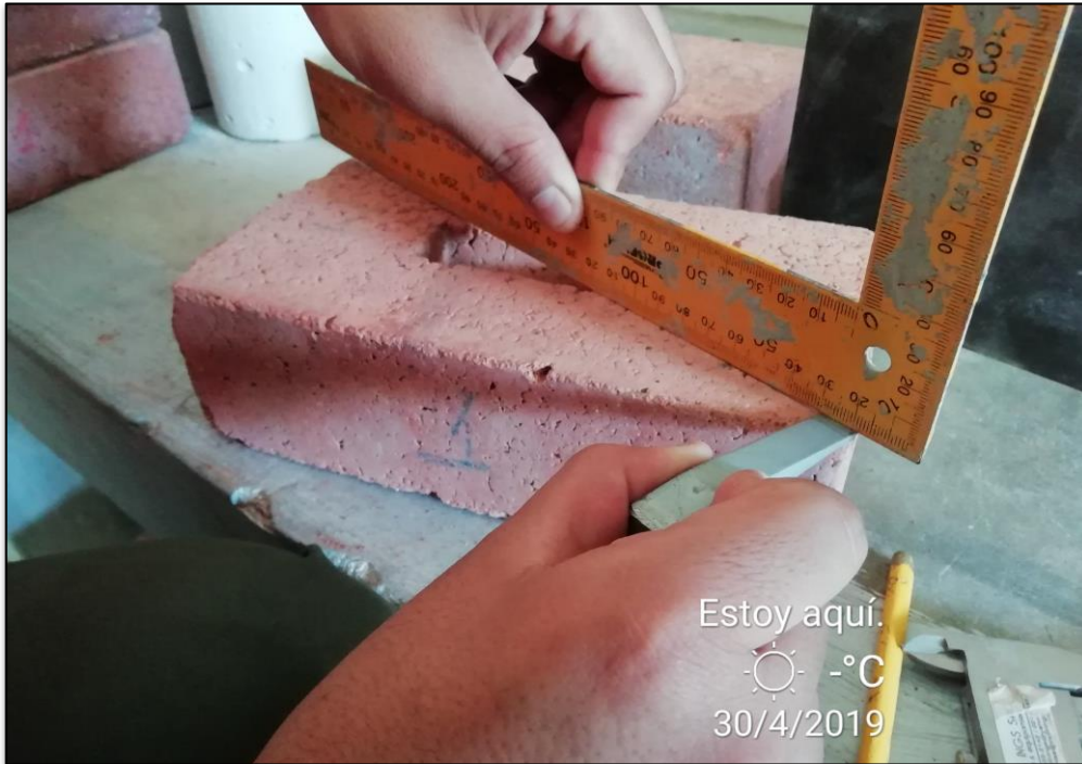
Figura 53: Vista del ladrillo de tierra comprimida siendo medida con una cuña.
