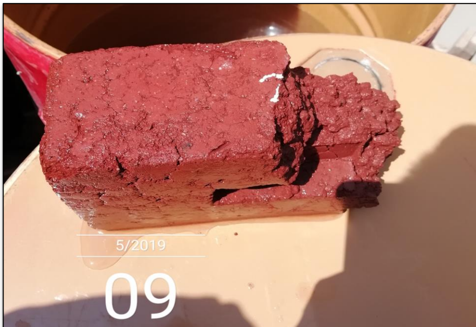
Figura 50: Extracción de ladrillo sumergido luego de 24 horas.
