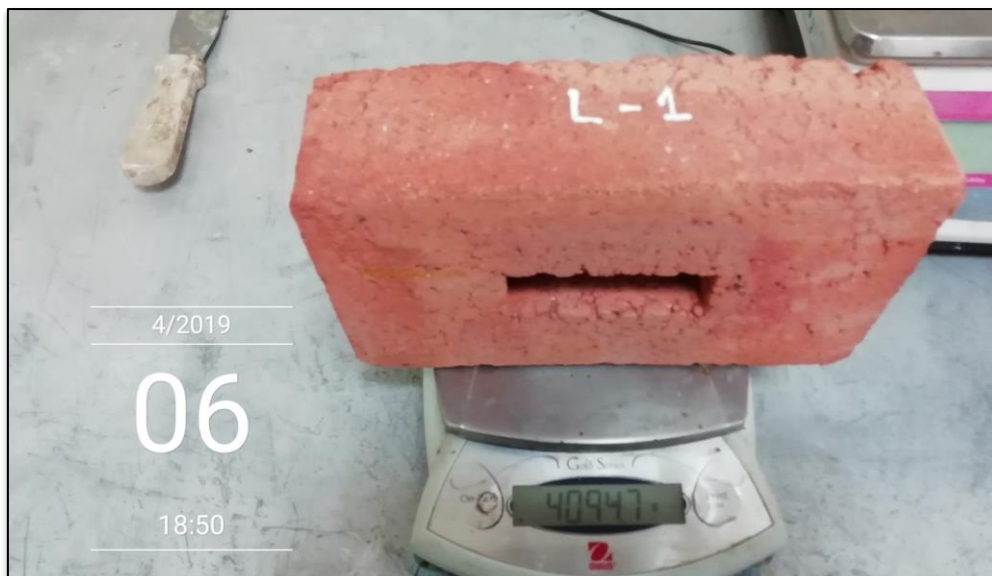
Figura 64: Pesando ladrillos en balanza con precisión de 0.1g.
