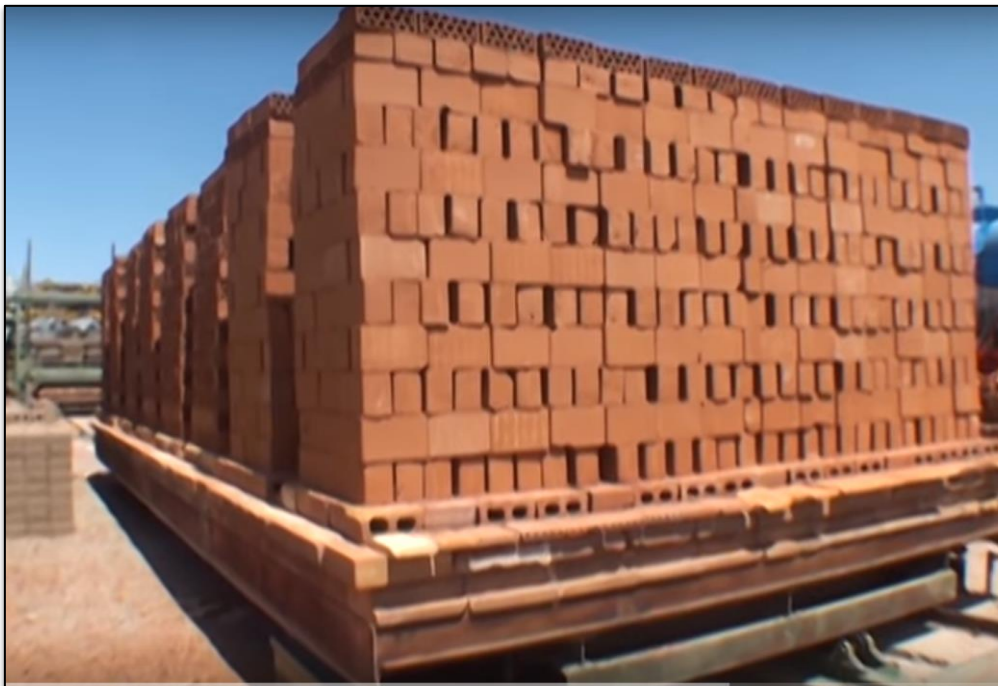
Figura 40: Ladrillo puesto en bloques para ingreso a horno.
