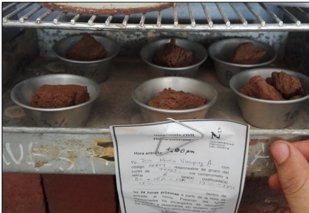
Figura 8: Muestra de los porcentajes de proctor colocados en horno.
