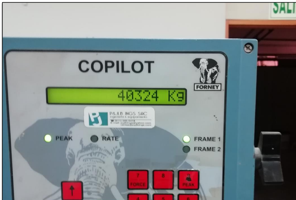
Figura 78 Tablero digital mostrando la carga resistida por el ladrillo.
