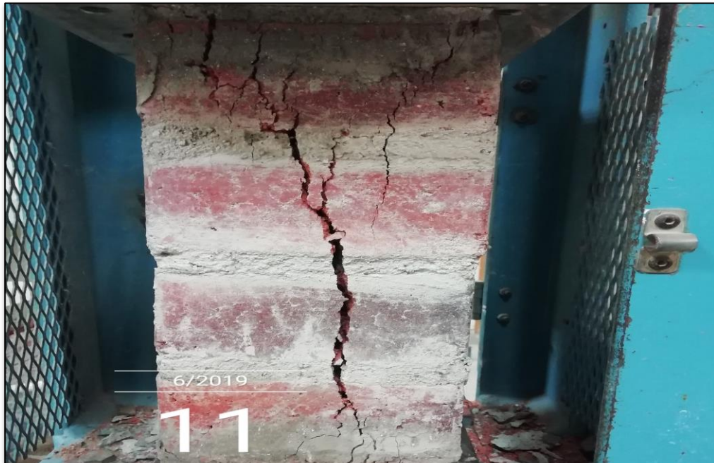
Figura 85: Tipo de falla de la pila.
