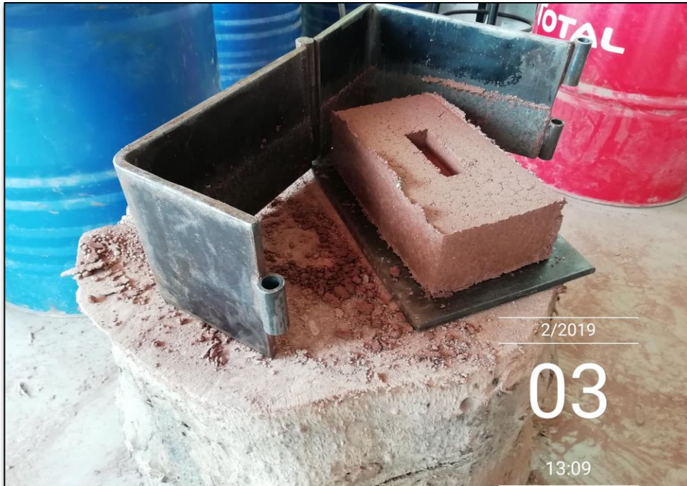
Figura 29: Desmoldado de ladrillo después de haber sido prensado.
