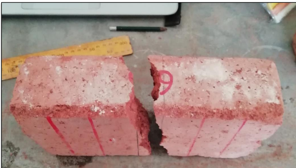
Figura 68: Fractura en medio de la muestra .
