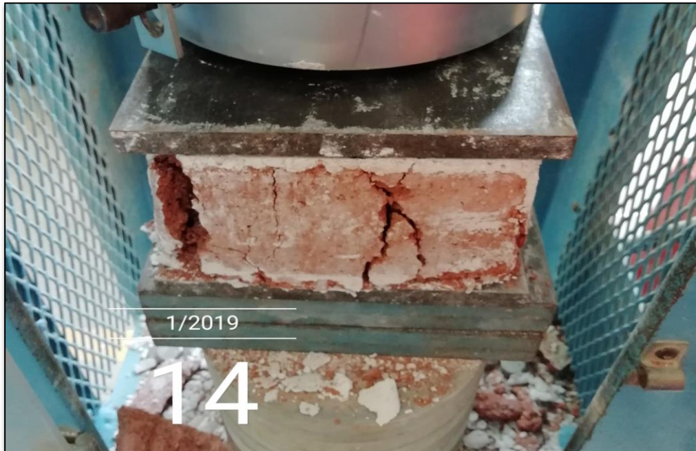
Figura 73: Resultado del ensayo a la resistencia a la compresión.
