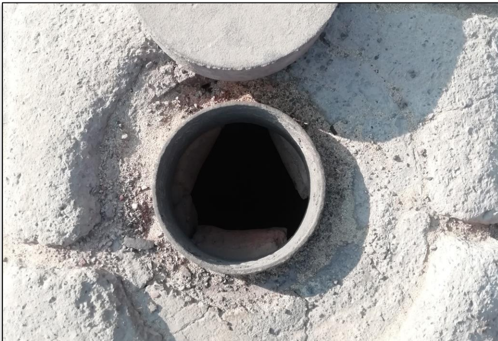
Figura 44: Zona por donde ingresa el combustible (cascara de arroz o café) para horno.
