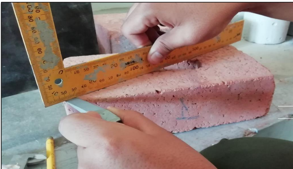
Figura 54: Vista del ladrillo de tierra comprimida siendo medida con una cuña..
