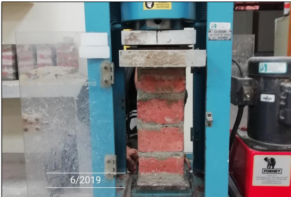
Figura 80 Ensayo de resistencia a la compresión por pilas.
