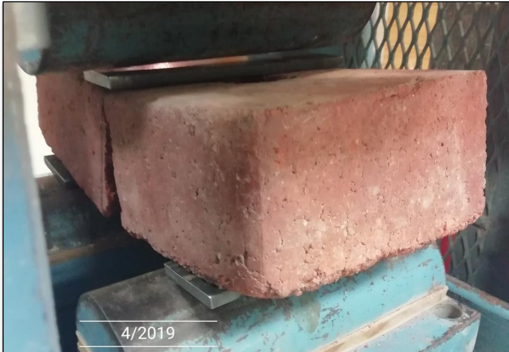
Figura 67: Se colocó 3 platinas de acero para este ensayo.
