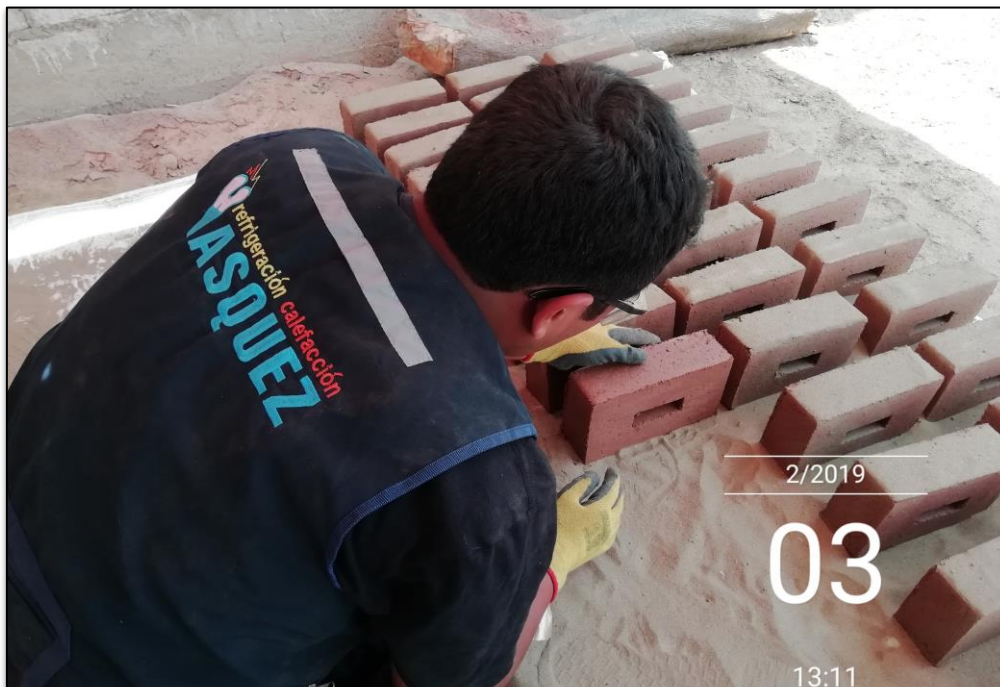
Figura 30: Colocación de ladrillo a secar.
