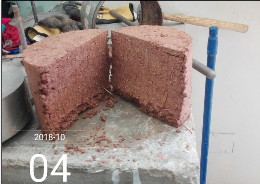
Figura 7: Extracción de muestra del ensayo de proctor.
