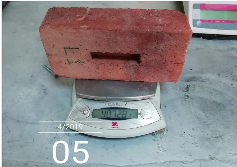
Figura 63: Pesando ladrillos en balanza con precisión de 0.1g.
