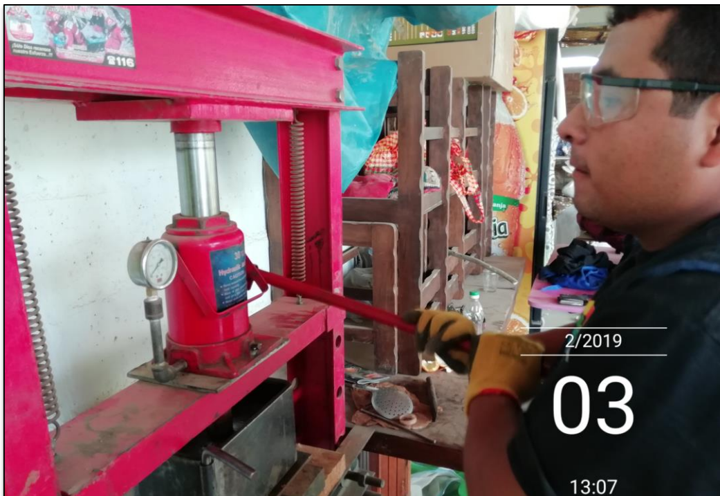
Figura 26: Prensado de ladrillo.
