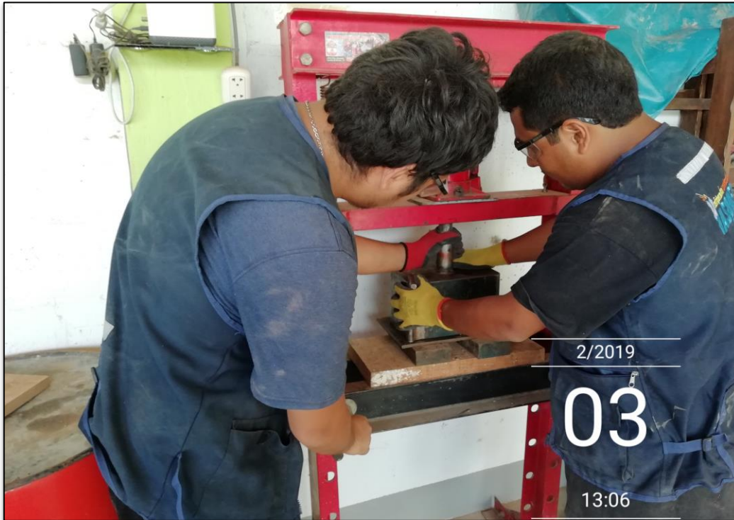
Figura 25: Colocación del molde en la prensa.
