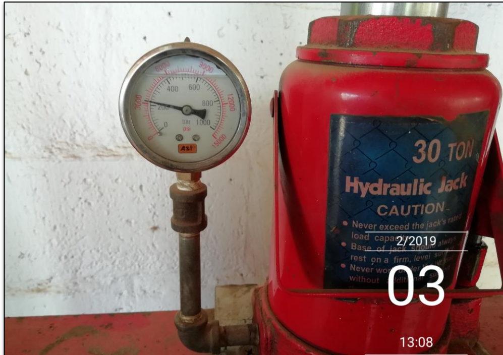
Figura 27: Prensado de ladrillo a 200 Bares.
