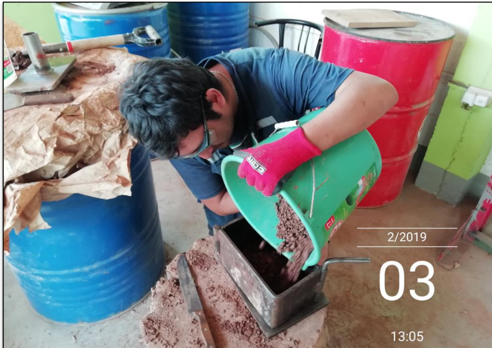
Figura 23: Colocación del material en el molde.
