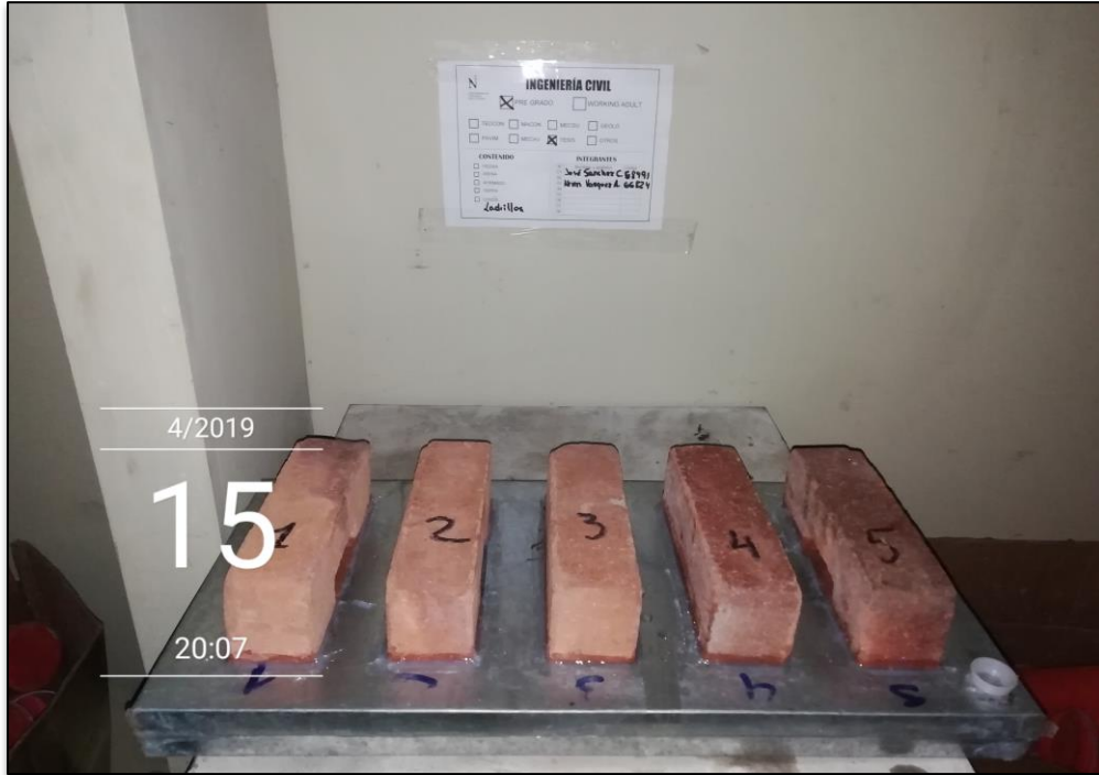
Figura 59: Ladrillos colocados en bandeja, sumergidos en agua destilada.
