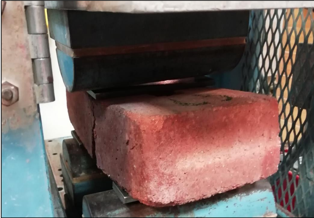
Figura 69: Se colocó 3 platinas de acero para este ensayo.
