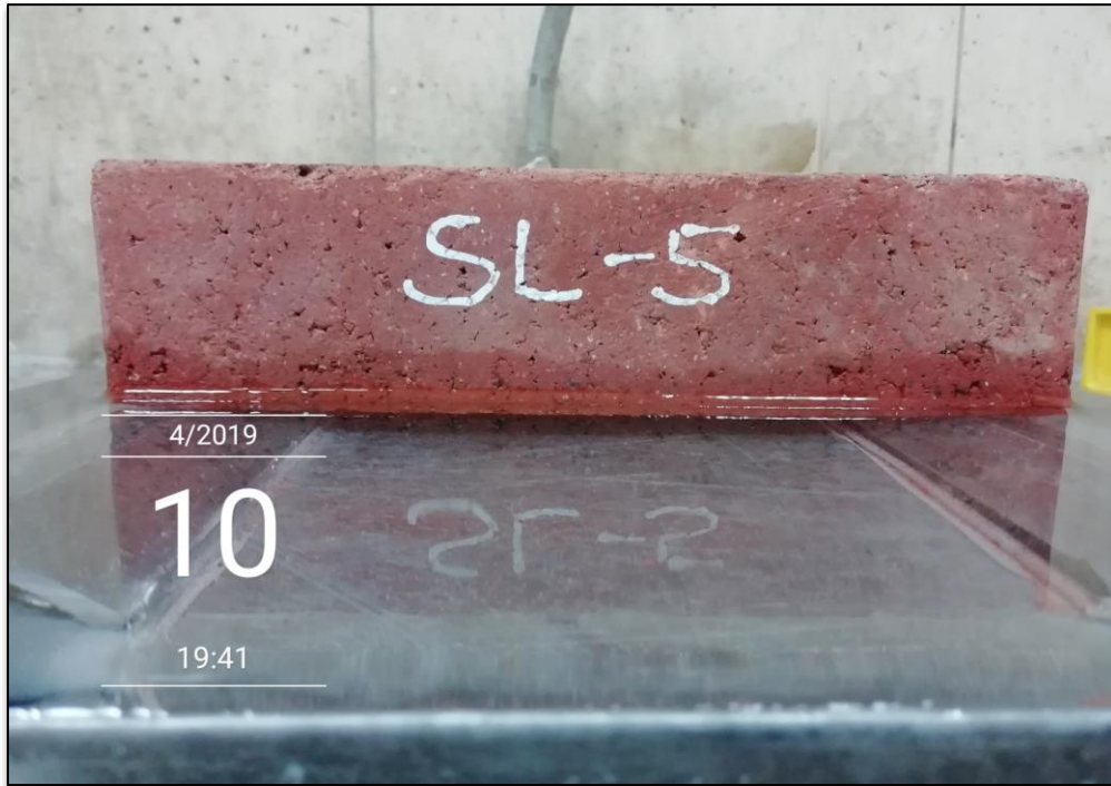
Figura 61: Ladrillos colocados en bandeja de succión durante 1 minuto cronometrado.
