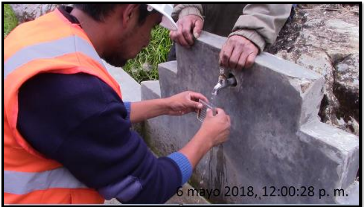
Toma de prueba de cloro de la última casa del sistema Morcilla Alta
