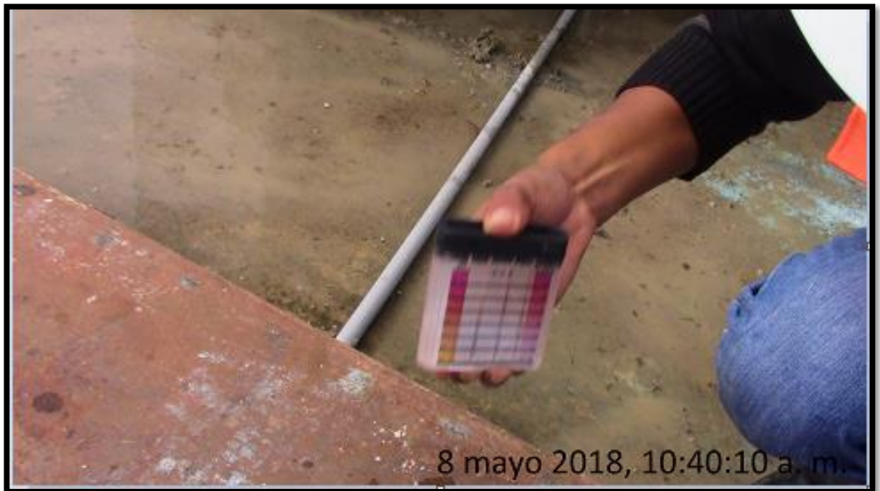
Prueba de cloro DPD en el reservorio del sistema de agua potable Laymina Las
