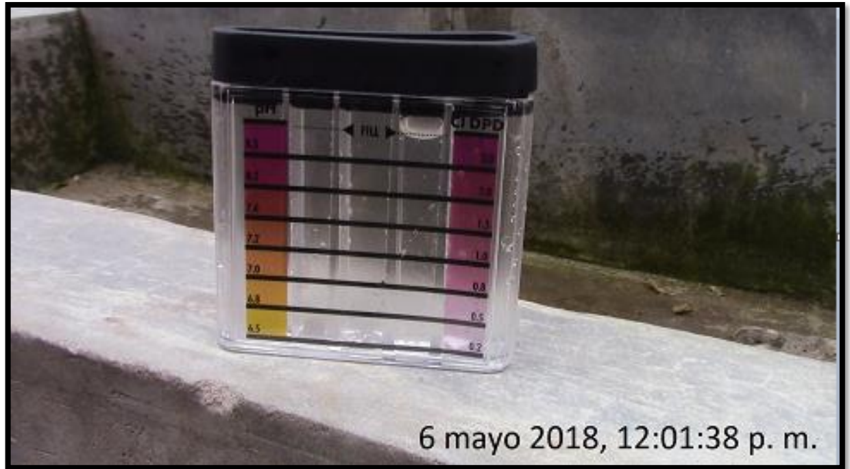
Toma de prueba de cloro de la última casa del sistema Morcilla Alta y como se observa el cloro no llega
