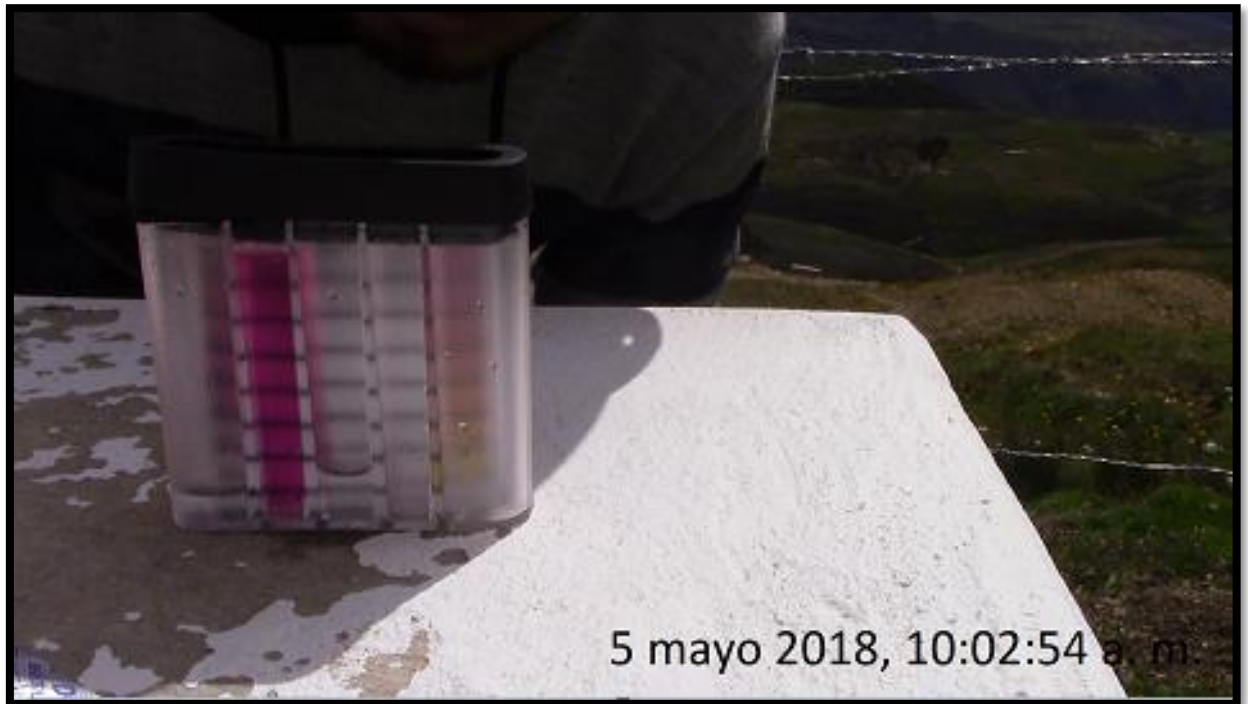
Prueba de cloro en el reservorio la cual se observa que está un nivel alto
