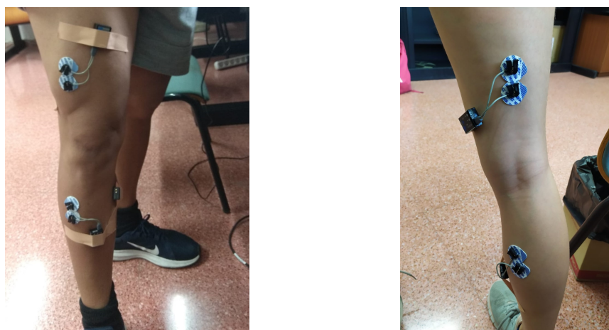
(a) Sensores en vasto lateral (superior) y tibial anterior (inferior). (b) Sensores en bíceps femoral (superior) y gastrocnemio medial (inferior).
