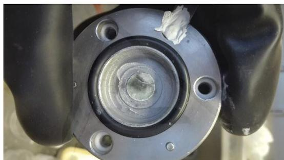
**Figura 6.10.** Estado del papel separador tras el estudio del límite de potencial negativo para un electrodo de IB de composición IB/NTs(7/5):PVDF 90:10 a  $5 \text{ mV}\cdot\text{s}^{-1}$  en  $\text{NaI}\cdot 3.3\text{NH}_3$ .
