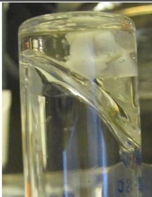
**Figura 4.14.** Aspecto del electrolito 1 M  $\text{NaClO}_4$  / PC cuando se añade una fracción molar de sulfolano de 0.20. Como se puede observar en la imagen la disolución queda completamente gelificada.
