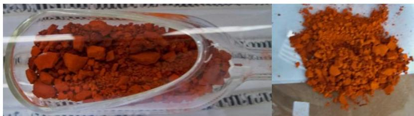
**Figura 2.9.** Aspecto final de PAQS después del proceso de secado a 120 °C a vacío durante una noche.
