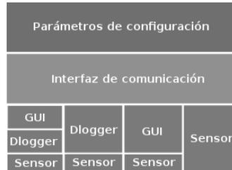
**Figura 2.** Diagrama en capas de la interfaz de comunicación.
