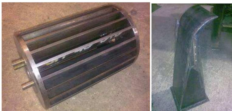
Figura 4 Conjunto del rotor e inyector
