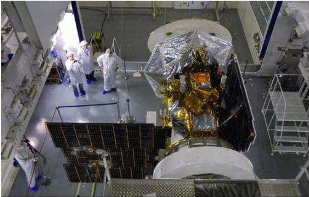
Figura 1: Paneles solares montados en el satélite SAC-D, en la base de lanzamiento en Vandenberg, California.
