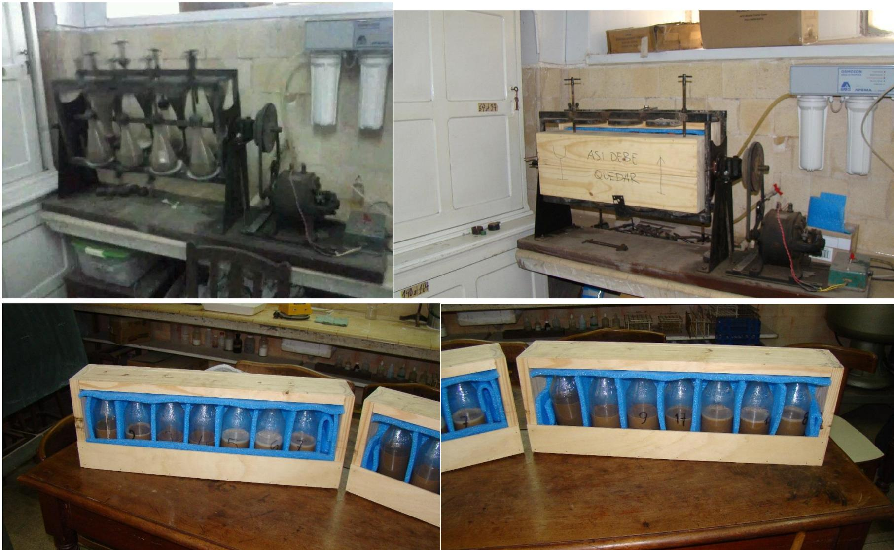
Imagen 9-2 Agitador rotativo, para dispersar mecánicamente, las muestras de suelos sin materia orgánica con dispersante químico y esferitas de vidrio para intensificar el proceso
