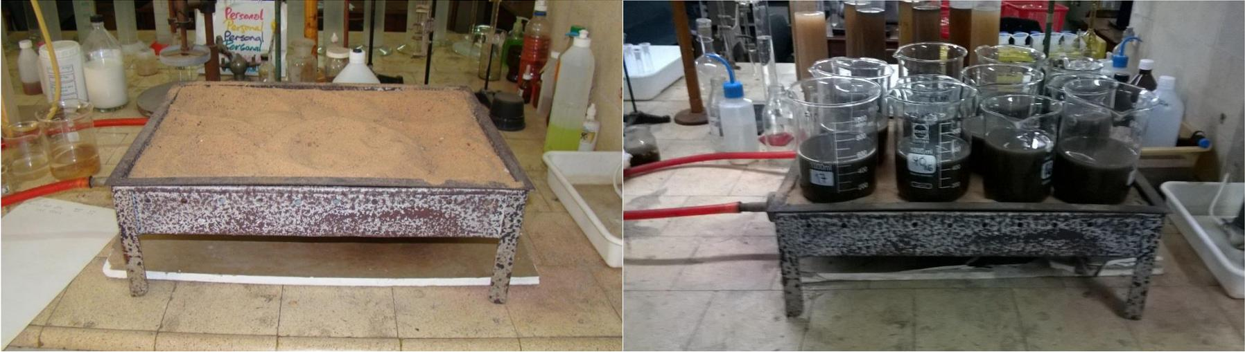
*Imagen 9-1 Cama de arena caliente, aumenta la temperatura y acelera el proceso de eliminar materia orgánica de las muestras de suelo empelando peróxido de hidrógeno*
