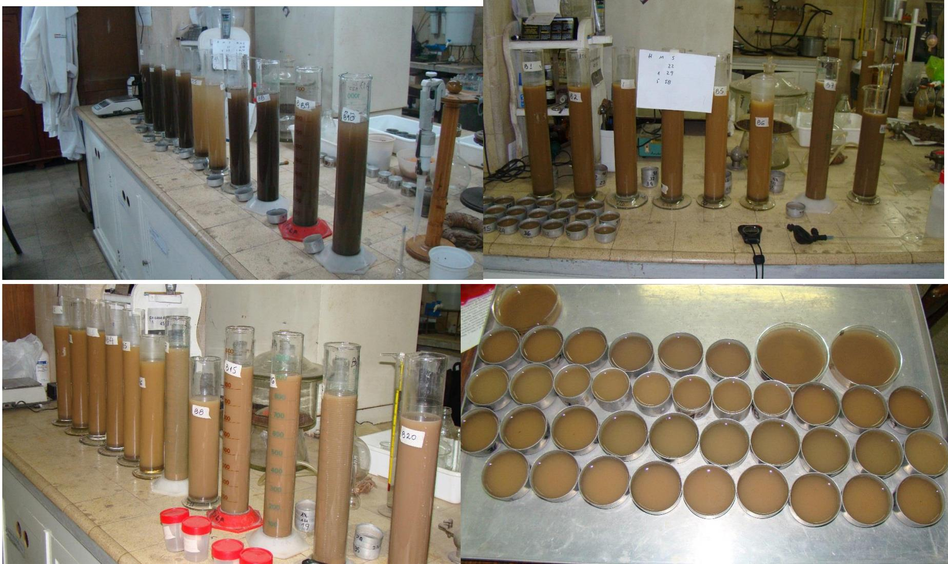
Imagen 9-6. Probetas sin materia orgánica, para realizar las extracciones a los tiempos estipulados. Bandeja con cápsulas con la alícuota obtenida de las probetas, previo a ir a la estufa para su evaporación. Se aprecia el color claro de las suspensiones
