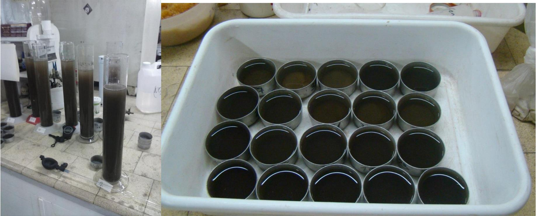
*Imagen 9-7. Probetas con materia orgánica, para evaluar la textura aparente, se aprecia el color de oscuro de las muestras en las probetas y las cápsulas*
