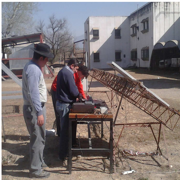
Figura 5: imágenes fotográficas de la estructura soporte de módulos fotovoltaicos y medición de radiación
