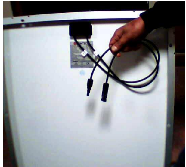
Figura 4: Detalle cables de conexión de un panel.
