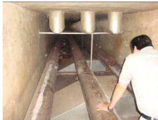
Figura 2 - Quemador del secadero (izquierda), caños de conducción de gases de combustión (derecha).
