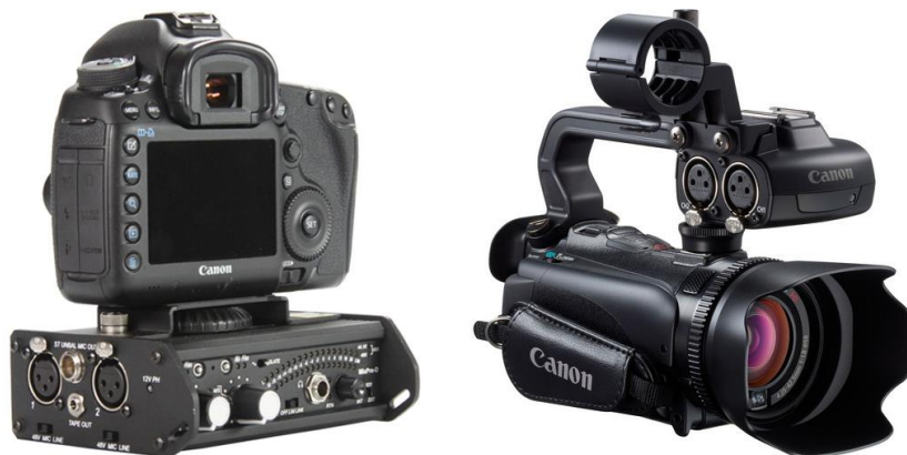
Sistema de grabación simple - entrada XLR.
