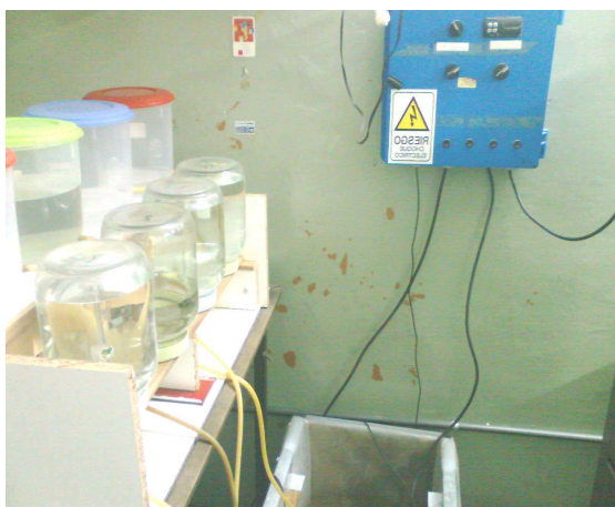
Figura 3: a) A la izquierda: parte de la unidad de generación de biogás. Sobre la pared el tablero de control. b) Detalle de la cuba donde se sumergió el BD-A junto al sensor, calefactor y agitador componentes del control automático de la temperatura del agua.
