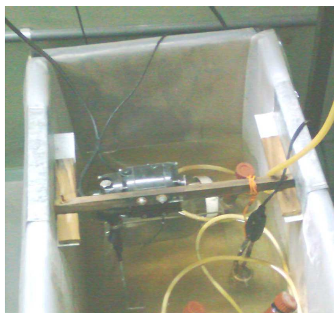
Figura 3: a) A la izquierda: parte de la unidad de generación de biogás. Sobre la pared el tablero de control. b) Detalle de la cuba donde se sumergió el BD-A junto al sensor, calefactor y agitador componentes del control automático de la temperatura del agua.
