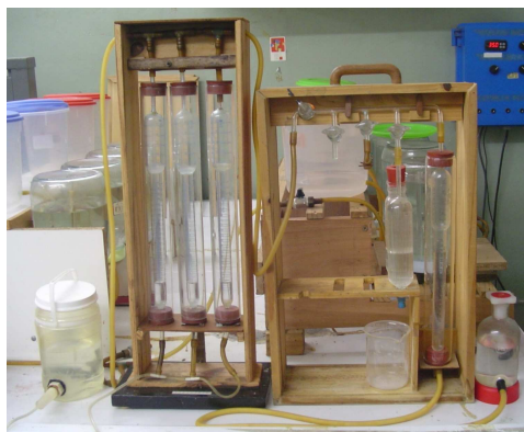
Figura 2: Imagen del conjunto de cuantificación de biogás y CO 2 , respectivamente las tres buretas y el aparato ORSAT. Atrás y a la izquierda la unidad de generación, al fondo a la derecha: el tablero de control.
