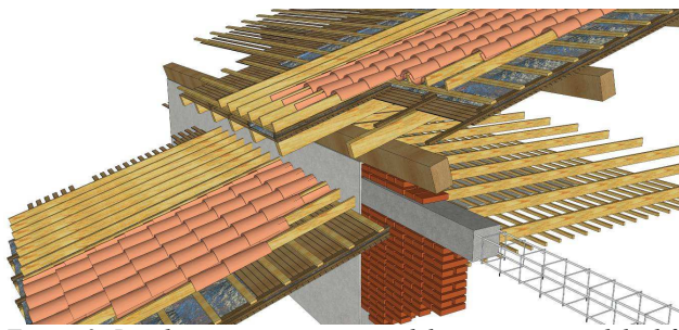
Figura 2: Resoluciones constructivas del sector antiguo del edificio de la FAU – UNNE: techos de tejas coloniales sobre estructura de madera y cielorraso independiente a la cal y muros de ladrillos macizos comunes de 30 cm. revocados.
