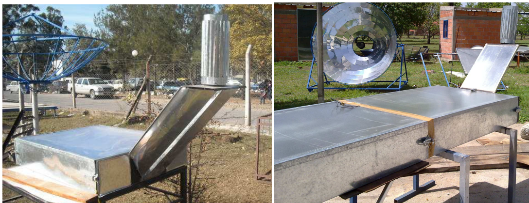
Figuras 1 y 2: Módulo de secado y chimenea CPC. Se aprecia el sistema de cerraje y acople entre los cajones y la chimenea.
