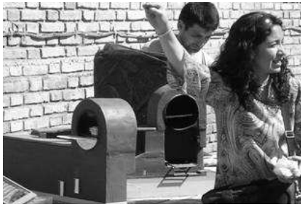
Figuras 26: Cocina-Horno con calentamiento de agua con uso racional de la biomasa.
