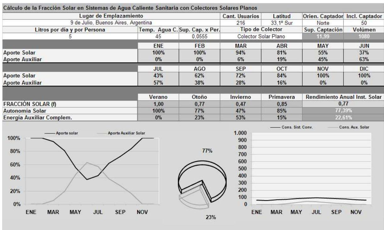
Figura 5: F-chart de instalación de agua de uso sanitario para 216 alumnos, 5 litro/alumno, fracción solar anual 77%.
