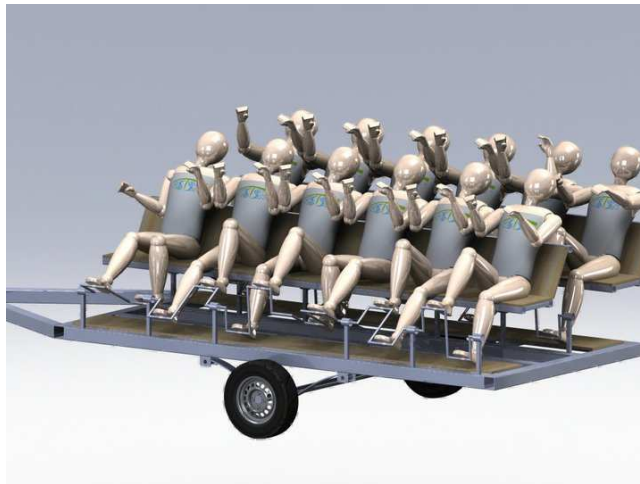
Figura 1: Dispositivo de doce asientos en dos filas de seis.
