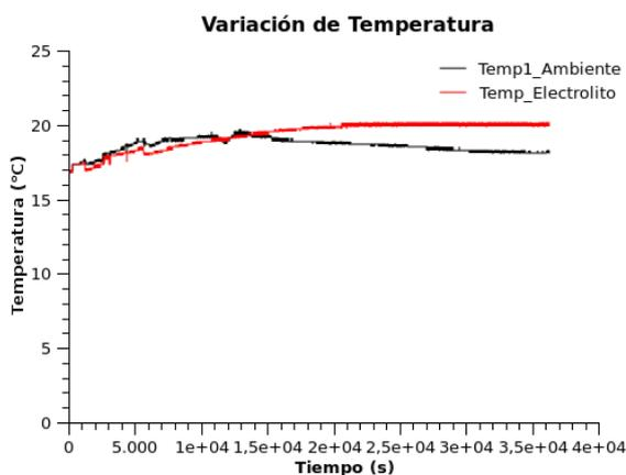
Figura 12. Variación de Temperatura en el proceso de carga por medio de una Corriente de 7A.
