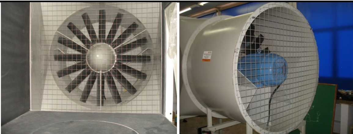
Figura 6: (a) Tela na saída da seção de ensaio, para proteção das pás do ventilador; (b) Tela de proteção na saída do túnel de vento.
