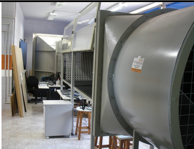
Figura 7: Vista geral do túnel de vento de camada limite atmosférica do LaCAF/FEC/UNICAMP.
