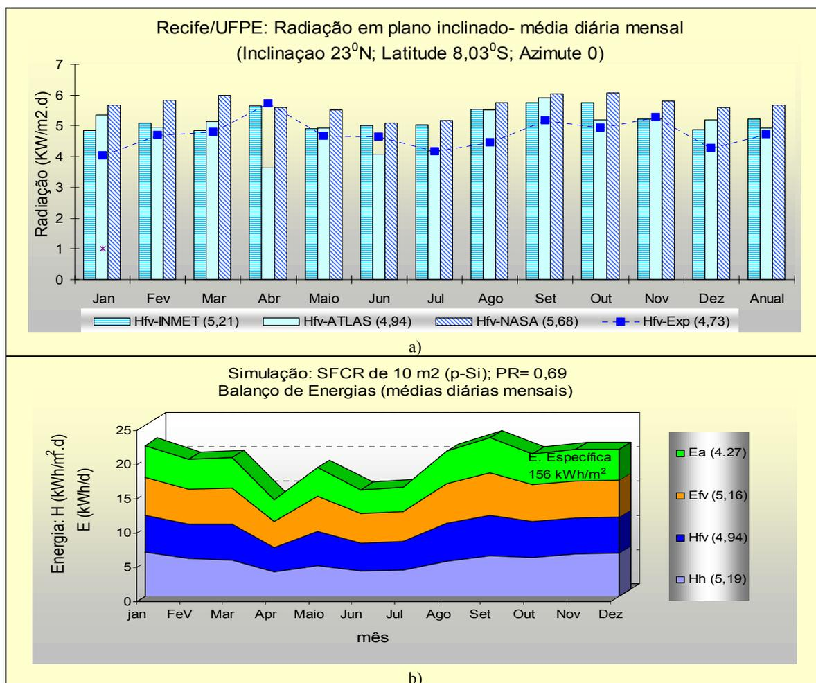
Figura 3: Cidade do Recife: a) Radiação incidente em um plano inclinado de 23°, faceando o Norte: Base de Dados: Atlas do Brasil, INMET e NASA; b) Balanço de energias e energia específica para o SFCR- Padrão (10m<sup>2</sup> de Si-poli).
