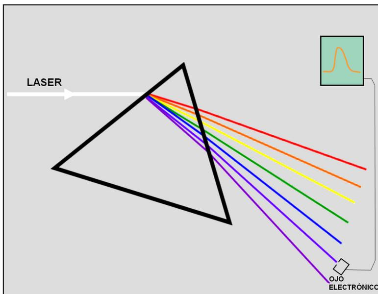
Tal como se indica en la figura, la señal que genera el detector (ojo electrónico) (2 x 2 mm de área), es enviada a una pantalla en la que se observa una altura del pulso, proporcional a la intensidad de luz que recibe. Como, en general, dicha intensidad es grande tratándose de un láser, resulta muy fácil la detección y del análisis de ella, es posible rescatar algunas características propias de un equipo Láser experimental.
