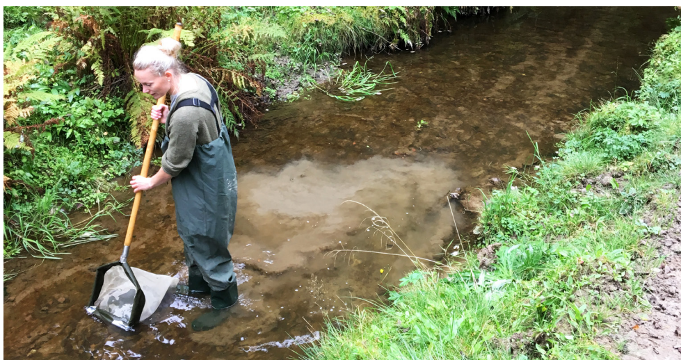
Kuva 27. Pohjaeläintutkimuksia varten näytteitä voidaan ottaa potkuhaavilla. Pohjaeläinten analysointi vie aikaa ja on siten kallista, joten tutkimuksia tehdään usein vain isompien hankkeiden yhteydessä.
