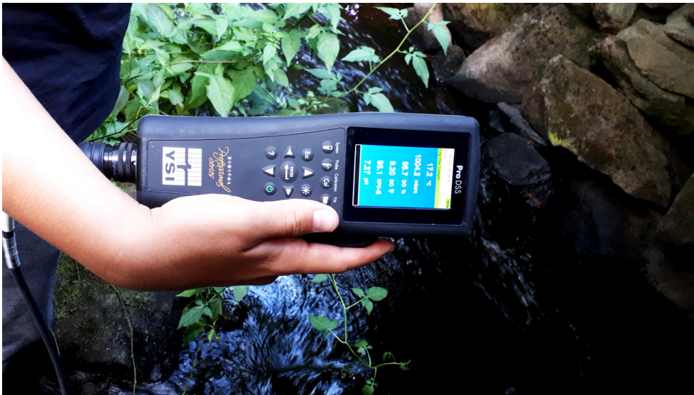
Kuva 28. Vedenlaadun seuranta kannettavalla anturilla. YSI Pro DSS kenttämittarilla voidaan mitata veden lämpötilaa, happipitoisuutta, sähköjohtokykyä ja pH:ta.
