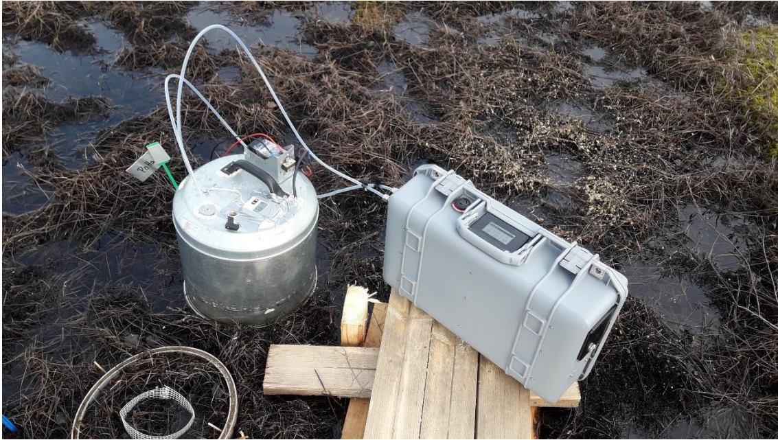
Kuva 4. LI-7810 kannettava kaasuanalysointilaitteisto yhdistettynä letkuilla mittauskammioon. Mittauskammio on kuvassa asetettu metallirinkulan uraan. Kuva: Petri Salovaara.
