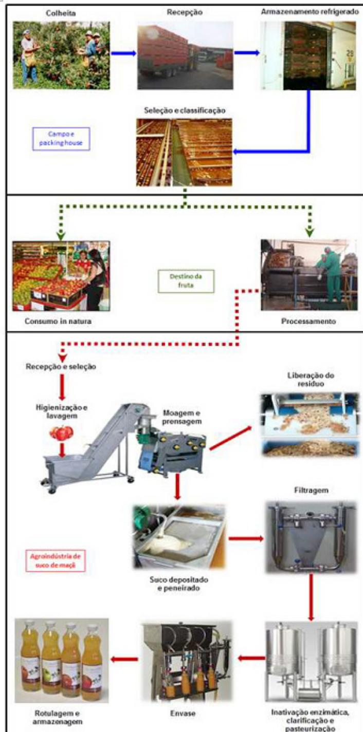
**Figura 1.** Fluxograma de produção de suco Integral de maçã utilizado na Embrapa Uva e Vinho.
