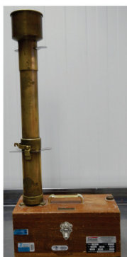
Balança Dalle Molle Peso do hectolitro (trigo em grão)
