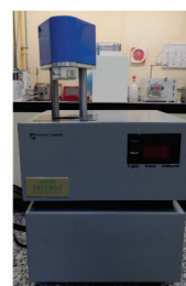
Viscosímetro RVA-3D, Newport Scientific (farinha de trigo)
