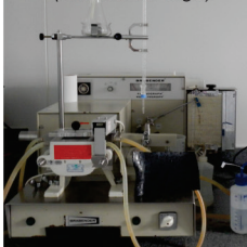
Farinógrafo, Brabender, com cuba de 50 g (farinha de trigo)
