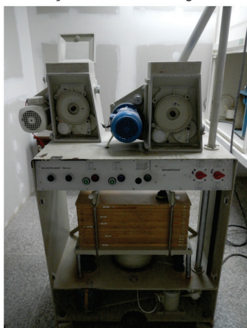
Alveógrafo, Chopin (farinha de trigo)
