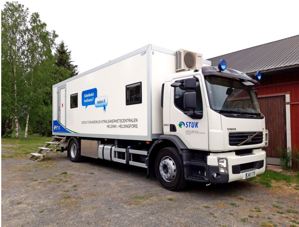
Kuva 10.1a. Kokokehomittauksissa käytettävä liikkuva laboratorio.
