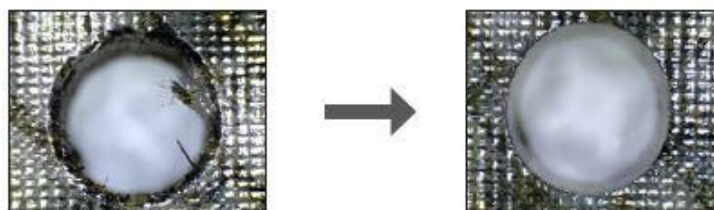
3.ábra Kompozit anyagok szálásodása fúrás során
