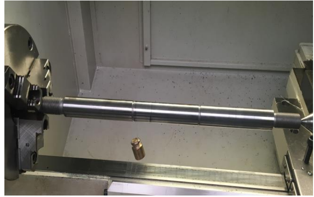
4. ábra. Fonálmódszer elvi a) és gyakorlati b) elrendezése [9]
