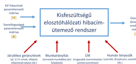
4. ábra. Kiefeszültségű hibacím ütemező rendszer egyszerűsített matematikai modellje
