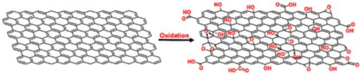
Figura 3. Oxidación de una lámina de grafito para formar óxido de grafeno 19
