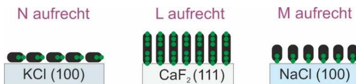
Abbildung 18: Substrat abhängige Orientierung des 6F-Pentacens 38b .
