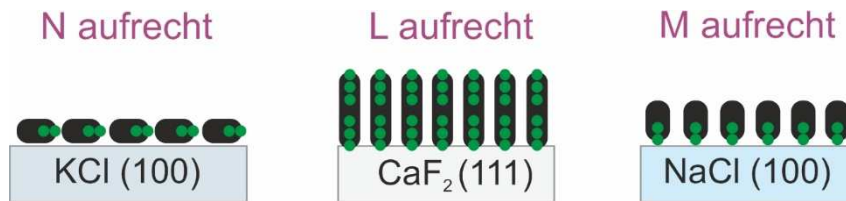
Abbildung 15: Orientierung von 6F-Pentacen 38b auf unterschiedlichen Substraten ermittelt durch die Auswertung von NEXAFS-Spektren.
