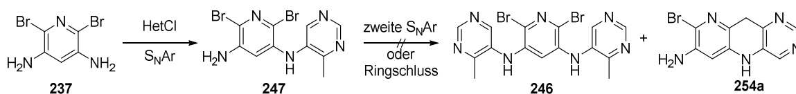
Schema 102: Synthese von Amin verbrückten Bisheteroaromaten 246 .
