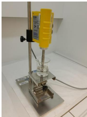
Obr. 14: Umístění vzorků v kádince pod ultrazvukovou sonotrodou.
