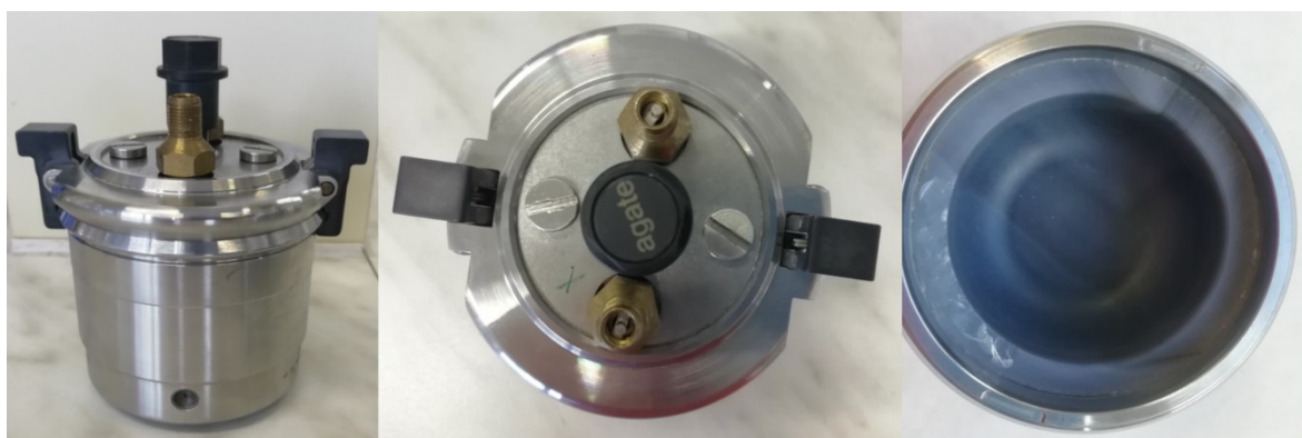
Obrázek č.17: Achátové mlecí nádoby umožňující mletí v ochranné atmosféře.
