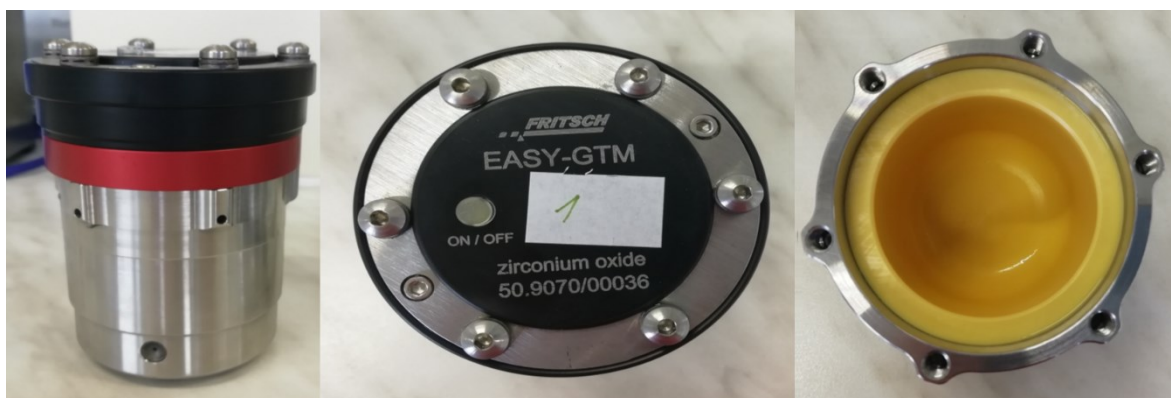
Obrázek č.18: Mlecí nádoby ze ZrO_2 umožňující měření teploty a tlaku během mletí.
