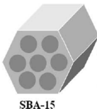
Obrázek 5: Struktura molekulárního síta SBA-15 [32]
