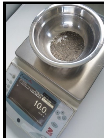
Obr. 22: Jednotlivé odvážení prosítovaných vzorků na 10,0 g
