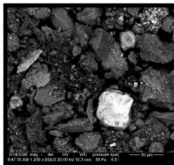
Obr. 86: Vzorek č.59 zirkon, ilmenit, TiO 2 , FeOx
