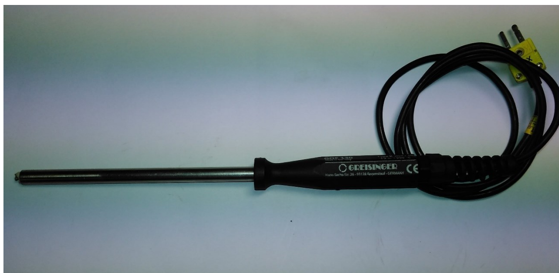
Obrázek 26 - Teplotní čidlo Greinsinger GOF 130, typ K (NiCr-Ni) [29]
