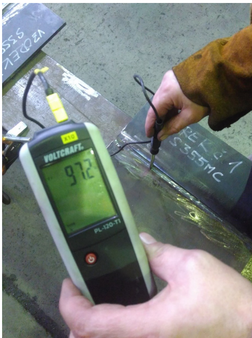
Obrázek 34 - Kontrola teploty předehřevu před položením třetí vrstvy u vzorku číslo 1
