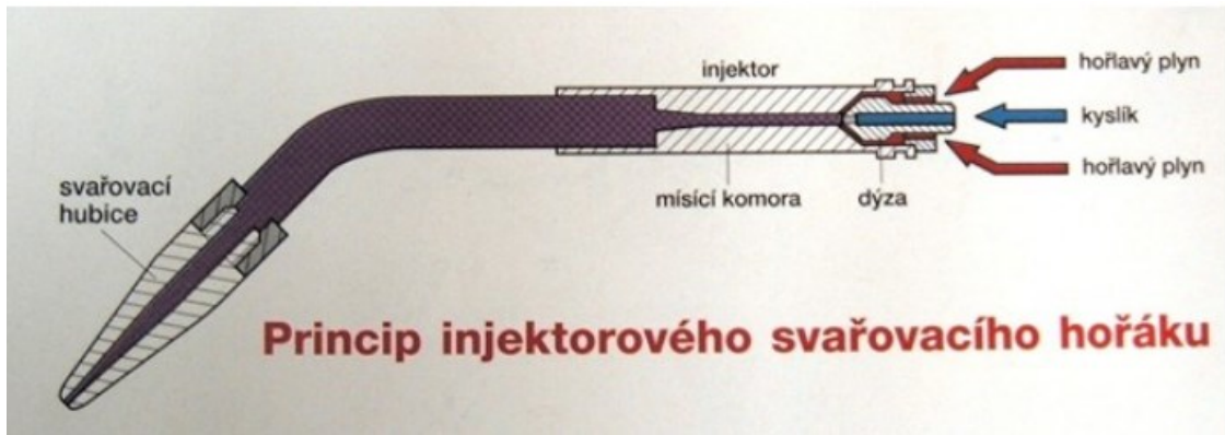
Obrázek 19 - Princip injektorového hořáku [2]
