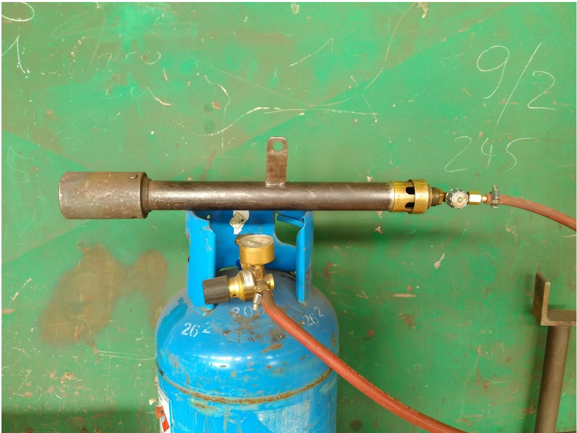
Obrázek 22 - Nahřívací hořák na propan-butan
