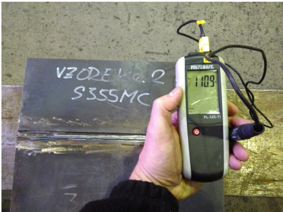
Obrázek 36 - Kontrola teploty interpass před položením druhé vrstvy u vzorku číslo 2
