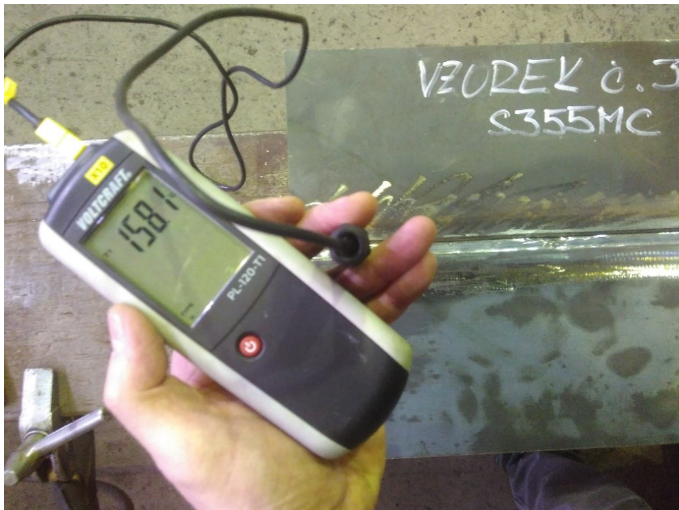
Obrázek 39 - Kontrola teploty interpass před položením čtvrté vrstvy u vzorku číslo 3
