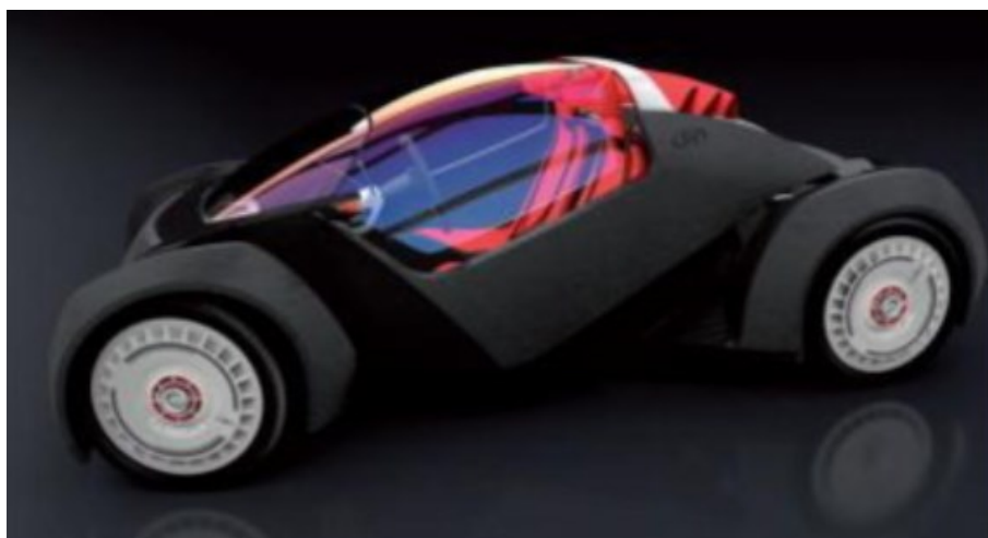
Obrázek 7 - Vytištěné vozidlo společnosti Sabic. Z části použitý materiál PA640 GLS. 44
