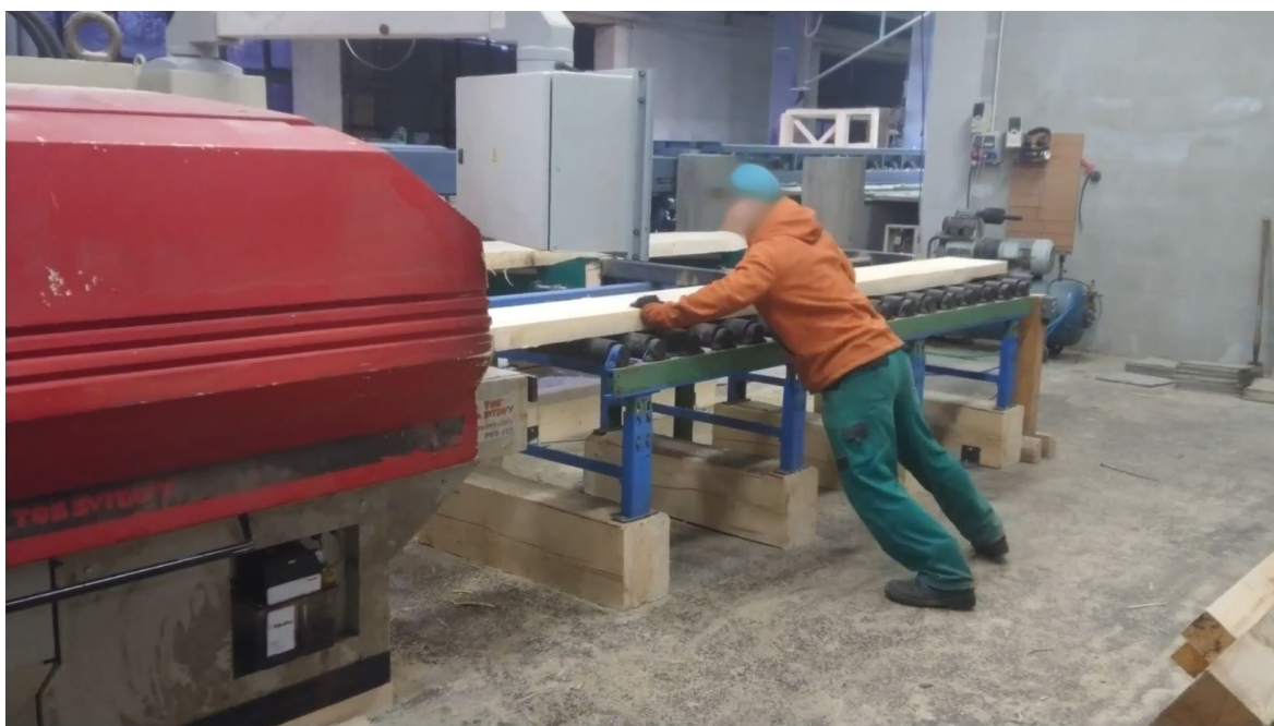
Obrázek 15 - Fáze 2 - Za stálého přitlačování prizmy k dorazu posouvání do rozmítací pily
