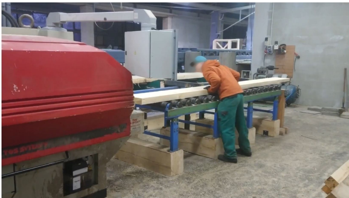
Obrázek 14 - Původní stav, fáze 1 - přitlačení prizmy na dorazovou lištu
