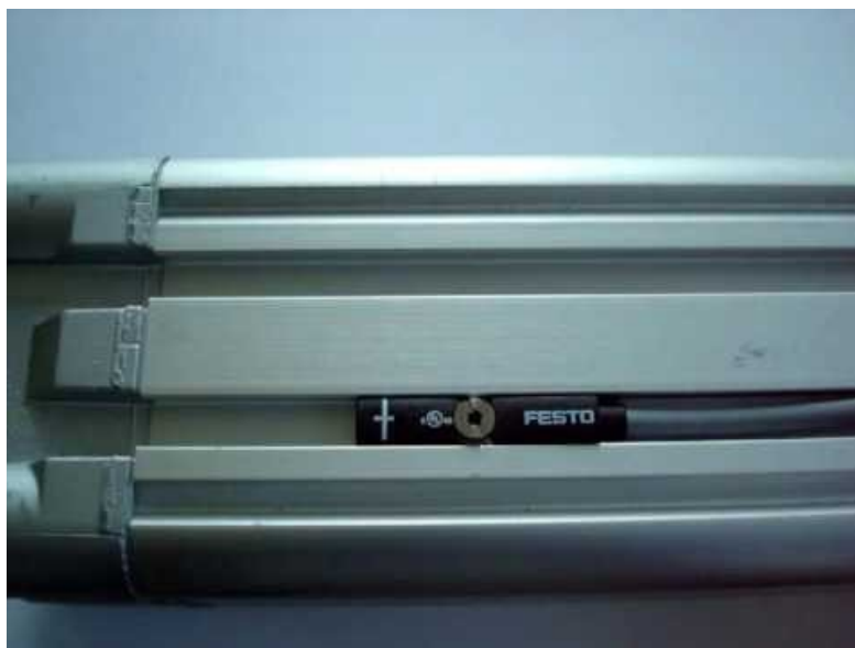
Obrázek 35 - Magnetický snímač polohy FESTO
