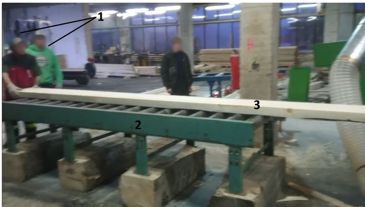
Obrázek 16 - Situace za rozmítací pilou, 1 - operátoři ukládající desky do balíku, 2 - původní válečkový dopravník, 3 - hotové řezivo
