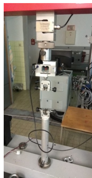
Obr. 31 – Připravené menší čelisti a citlivější tenzometrický snímač na trhacím stroji Testometric M500-50CT
