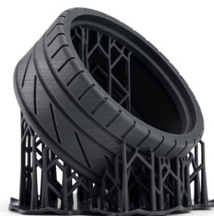
Obr. 3 – Vytištěná pneumatika s podporami kvůli vhodné orientaci při tisku [9]
