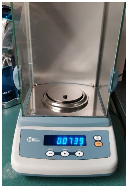
Obr. 3.2 – Měření hmotnosti jednoho filtru za pomoci laboratorní váhy BEL ULTRA MARK 120.
