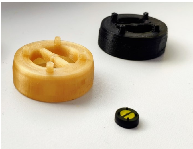
Obr. 3.3 – Srovnání modelů z 3D tiskárny a skutečného filtru
