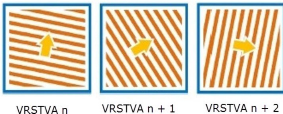
Obrázek 10.2 - Pootočení vrstev u strategie Meander [30]
