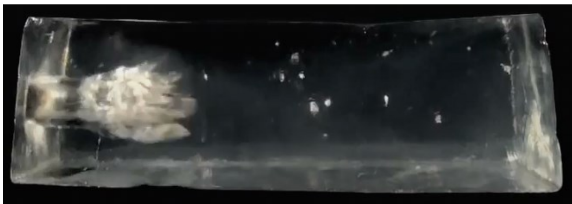
Obr. 6.3: Vznik dočasné dutiny, ráže 9 mm
