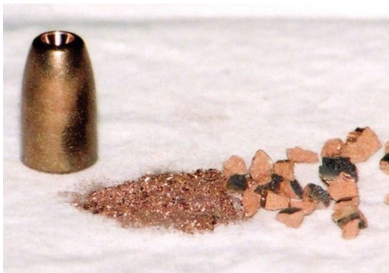
Obr. 3.1: Střela frangible před a po výstřelu
