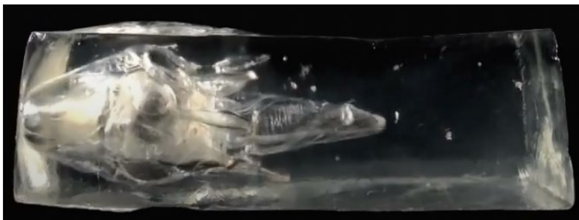
Obr. 6.4: Vznik dočasné dutiny, ráže 9 mm
