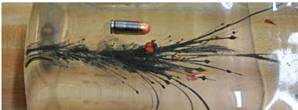
Obr. 3.3: Blok balistické substance po zásahu střelou ultrafrangible
