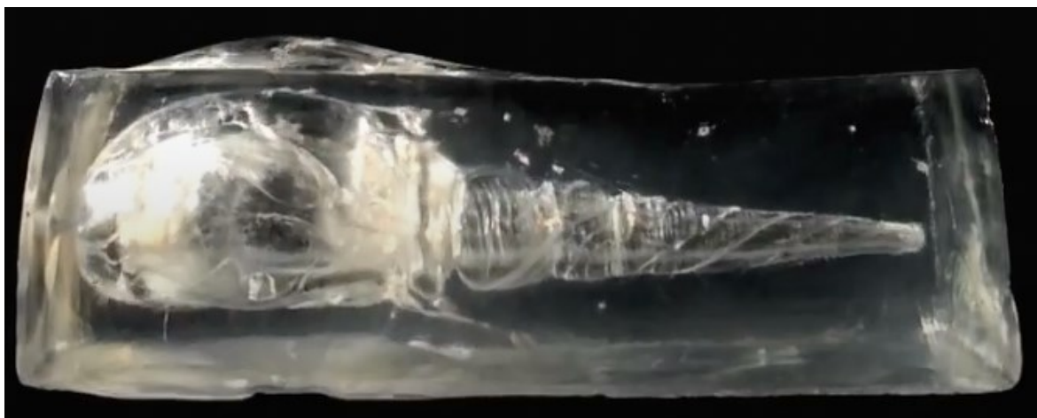
Obr. 6.5: Vznik dočasné dutiny, ráže 9 mm Zdroj: https://www.youtube.com/watch?v=97h1XHTi6us
