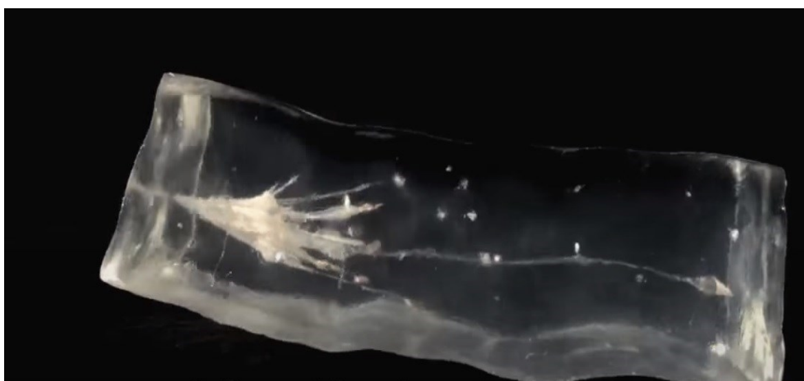
Obr. 6.2: Průnik střely 9 mm FG do balistického gelu Zdroj: https://sinterfire.com/media/videos/
