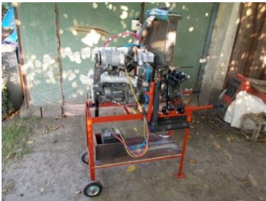
Obr. 8 – Držák motorů Jawa Minor [7]
