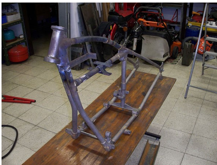
Obr. 10 – Rám motocyklu BSA 550 SV 350 model 1933
