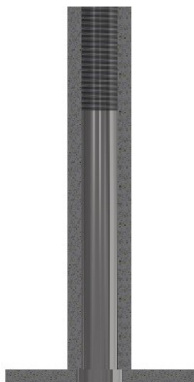
Obr. 29 – Pohle na těleso zvedáku v řezu
