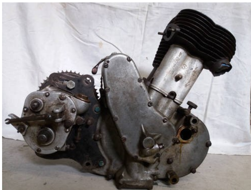
Obr. 11 – Motor s převodovkou motocyklu BSA 550 SV 350 model 1933
