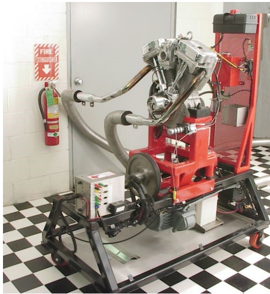
Obr. 3 – Zkušební stolice připojena k dynamometru [2]
