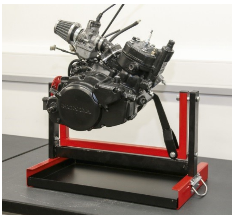
Obr.2 – Montážní stoličky motorů pro malé kubatury [1]
