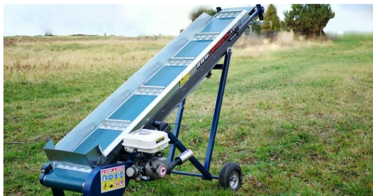
Obr. 26 Dopravník poháněný spalovacím motorem [50]
