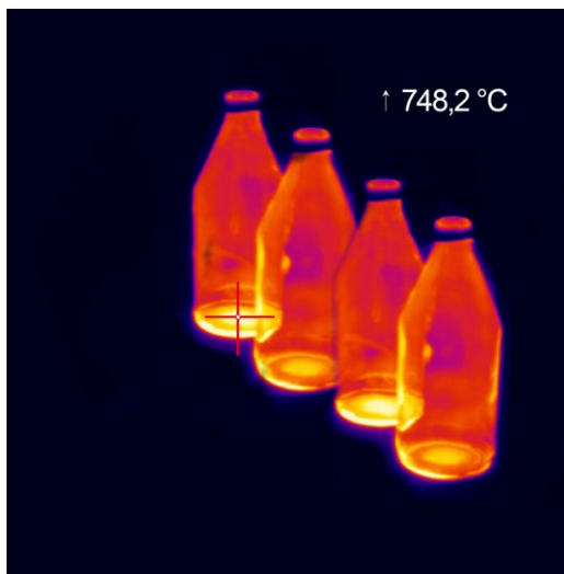
Obr. 33 Měření teploty v silikátovém průmyslu [10]
