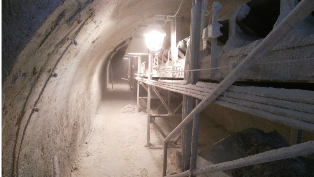
Obr. 44 Pásový dopravník pro přepravu vápence [autor]
