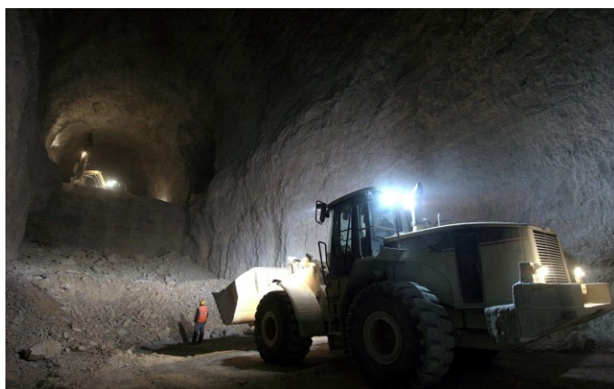
Obr. 4 Podpvrchová těžba vápence [37]
