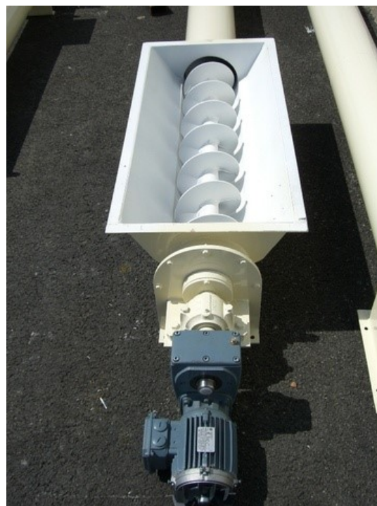
Obr. 10 Šnekový dopravník s násypkou [27]
