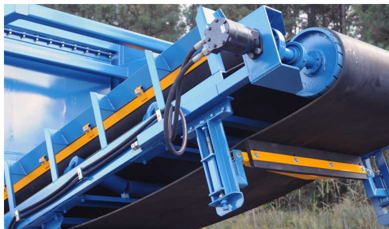
Obr. 27 Dopravník s hydraulickým pohonem [51]
