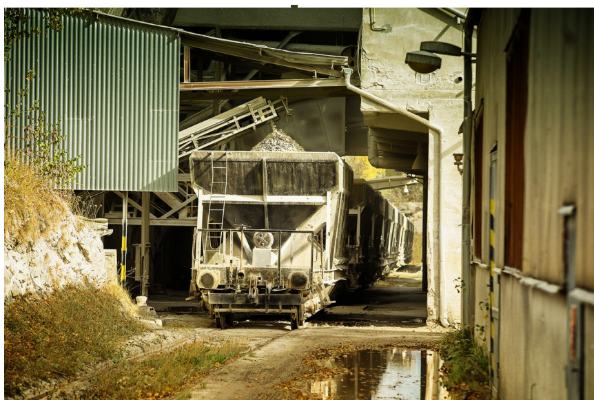
Obr. 9 Nakládání vápencové sutě do vagonů [24]
