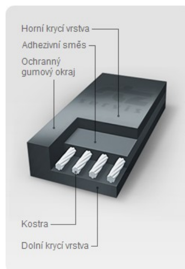
Obr. 13 Řez ocelokordovým pásem [29]
